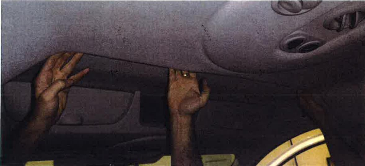
Desmontar plafon de iluminación y soltar las conexiones.
