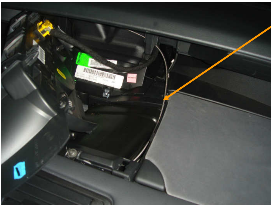
Figura 5 y 6. Paso de manguera de señal hasta la parte superior del salpicadero.
