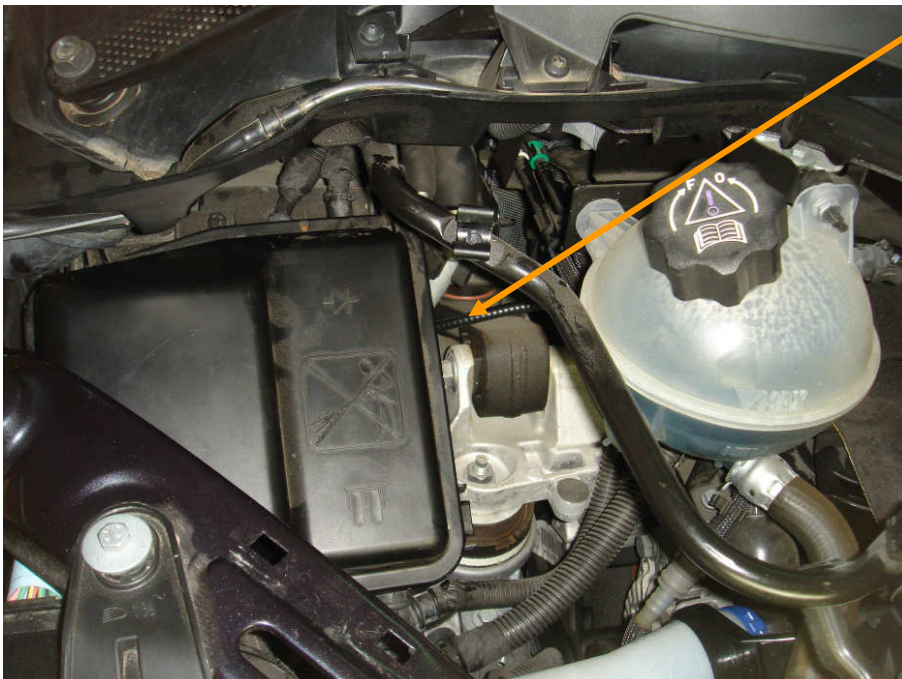
Figura 1 y 2 canalización de manguera de señal hasta caja porta fusibles.
