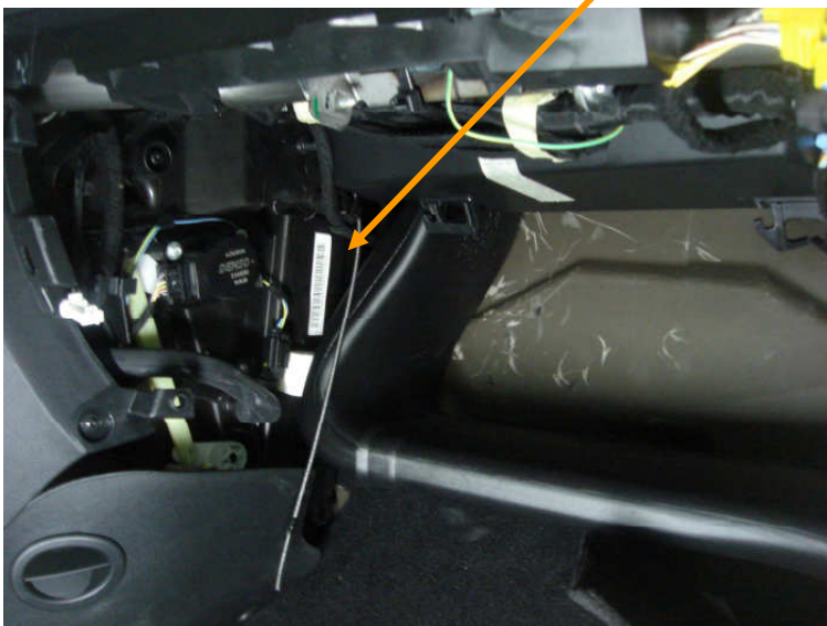
Figura 2, 3 y 4. Canalización de manguera de alimentación de batería a taxímetro.
