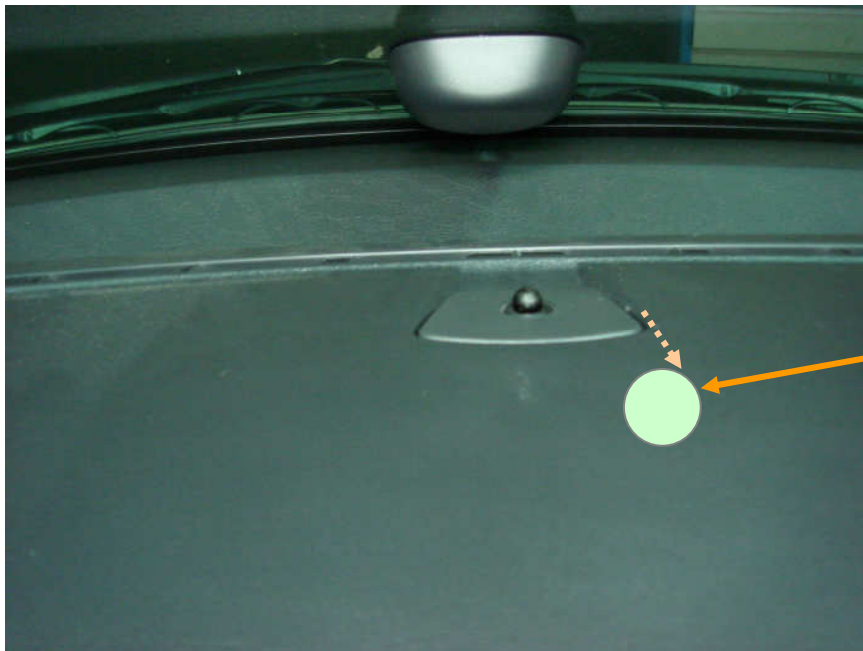
Figura 5. Orificio en salpicadero para canalización de mangueras a taxímetro.
