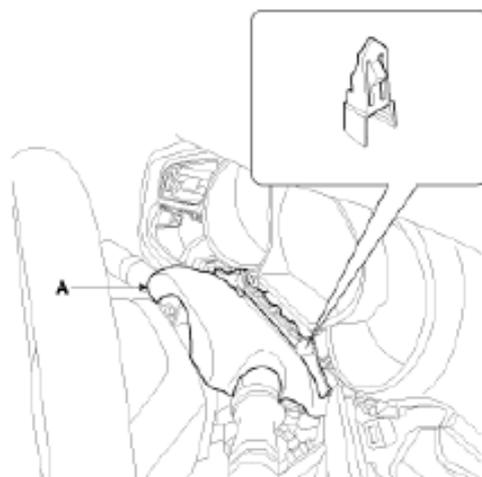
4. Con un destornillador o desmontador, retire el panel del cilindro del cuadro de instrumentos (A).
