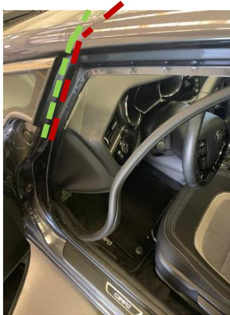
**Fig. 4.9.** Recorrido del cableado por el interior del guarnecido del marco de la puerta hacia el módulo y hacia el taxímetro de espejo, en su caso.
