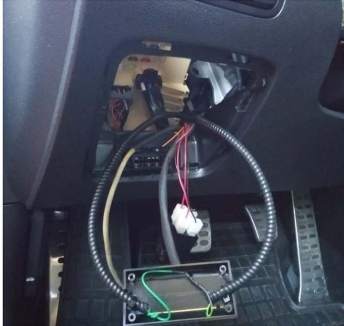
*Fig. 3.1. Imagen de la caja de conexiones y cables de señal enfundados en manguera blindada*
