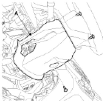
3. Con un destornillador o desmontador, retire el panel superior de la cubierta de la columna de dirección (A)
