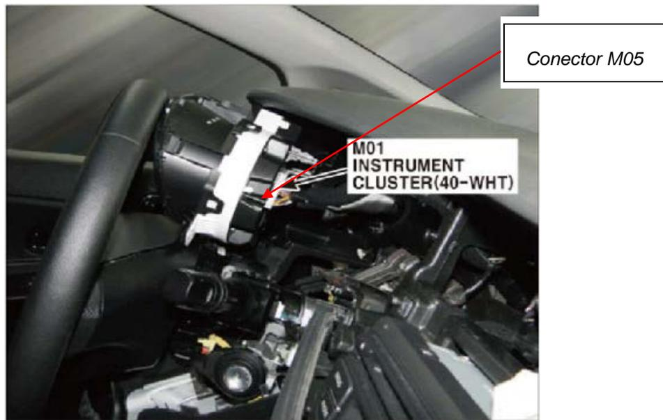
*Fig. 1.1. Vista de la ubicación del conector M01 detrás del cuadro de instrumentos*
