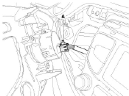
7. Tras aflojar los tornillos de fijación, retire el conducto de ventilación central (A).
