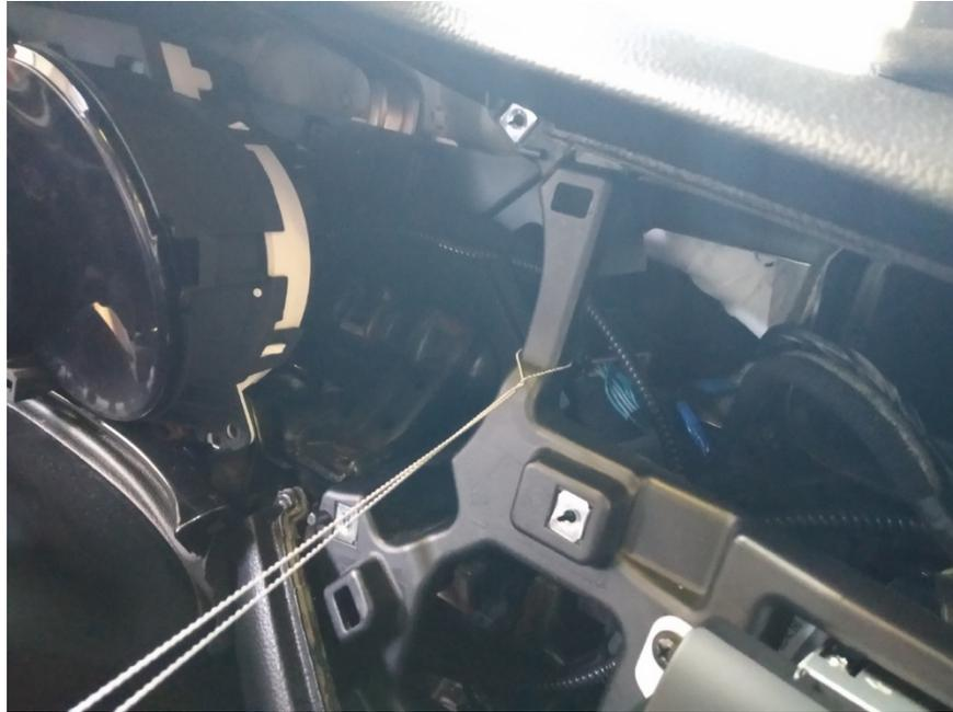
*Fig. 1.7. Precintado del cuadro de instrumentos. Sujeción el alambre*
