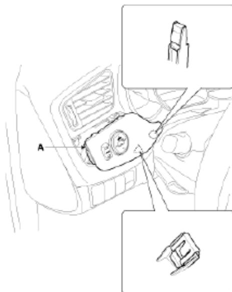
2. Desconecte el conector del interruptor del retrovisor eléctrico de la puerta (A).
