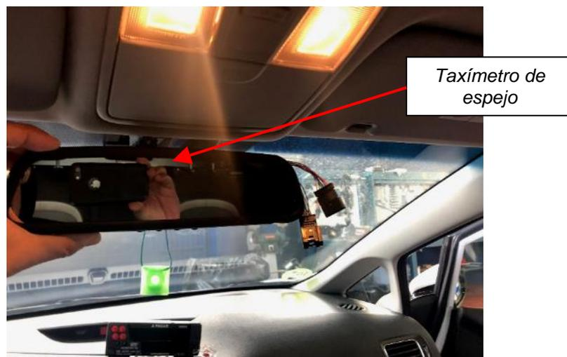
Fig. 4.7. Vistas de la disposición del taxímetro de espejo.
