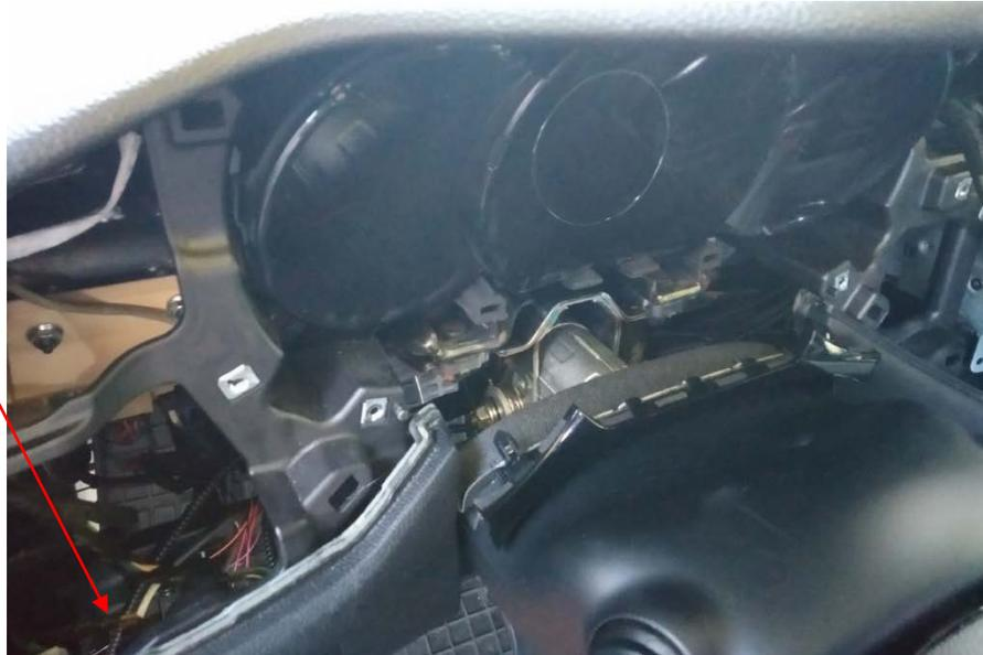
**Fig. 1.5.** Detalle del paso de manguera al compartimento motor.
