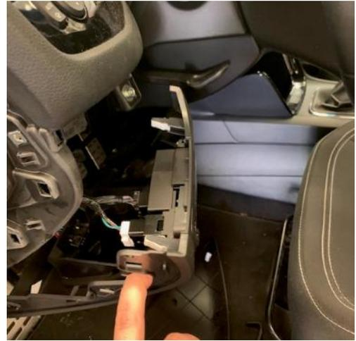
*Fig. 3.2 - 3.3 - 3.4 - 3.5. Desmontaje paneles laterales salpicadero*
