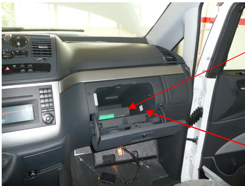
Fig. 2.2. Vista de la caja adaptadora de señal precintada, fijada debajo de la guantera
