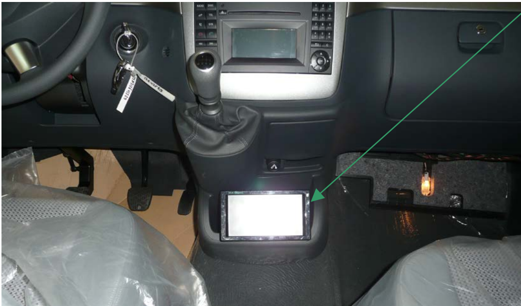
Fig. 5.4. Vista de la zona permitida para la instalación de la pantalla para taxímetro con pantalla independiente / control de flotas.
