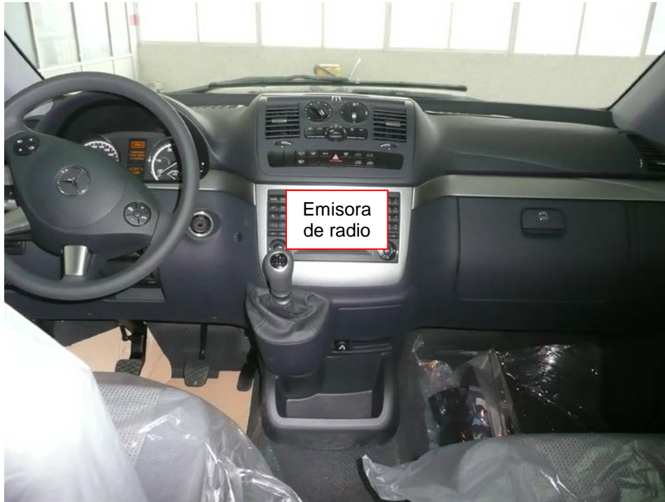
Fig. 8.2 Vista del emplazamiento de la emisora de radio.
