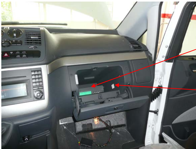
Fig. 8.1 Vista del emplazamiento del módulo de emergencias integrado en la caja adaptadora de señal.
