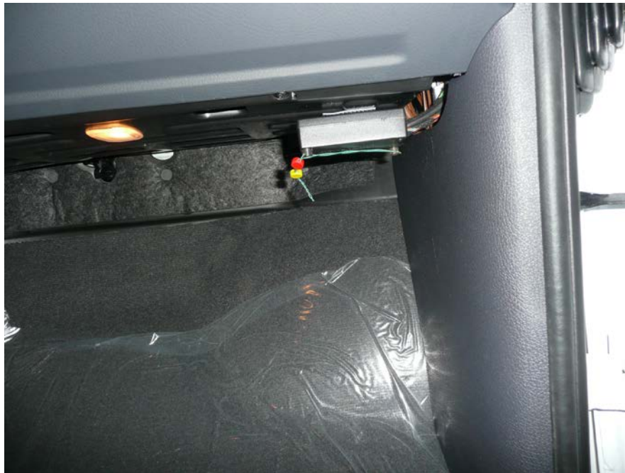
Fig. 2.2. Vista de la caja adaptadora de señal precintada, fijada debajo de la guantera
