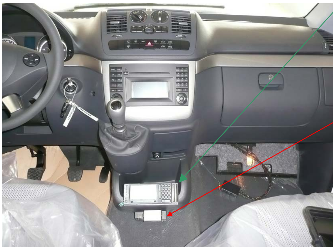
Fig. 5.3. Vista de la zona permitida para la instalación del taxímetro convencional.
