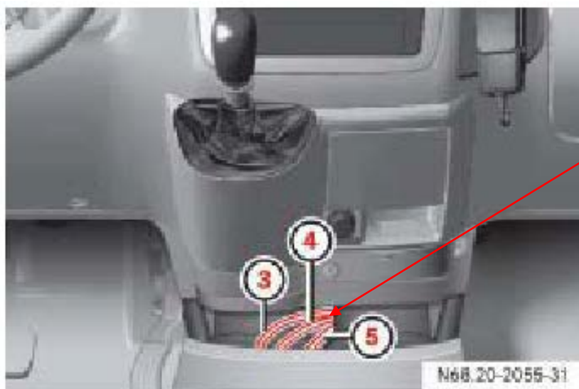
Fig. 6.2. Vista de detalle de los cables para periféricos en la consola inferior.
