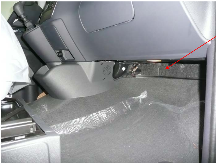
Fig. 6.4. Vista de la tapa cubrecables debajo de la guantera.
