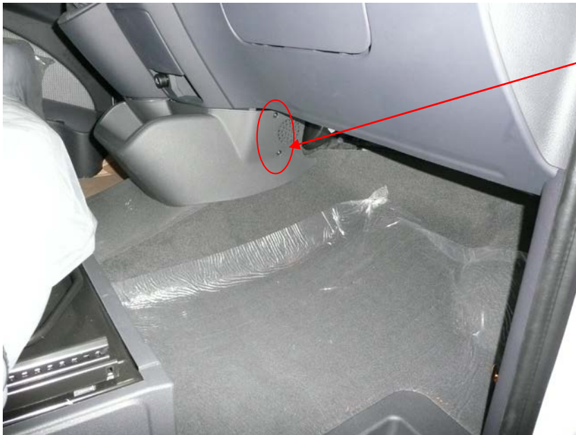
Fig. 6.3. Vista de la consola inferior lado derecho, con indicación de la ubicación de los tornillos torx.
