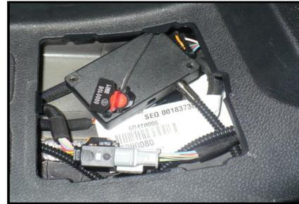
Se llevará la manguera blindada desde la caja precintada de la talonera de puerta por la moldura lateral hasta la zona bajo el volante, donde se dejará enrollada a disposición del instalador del equipo taxímetro.
