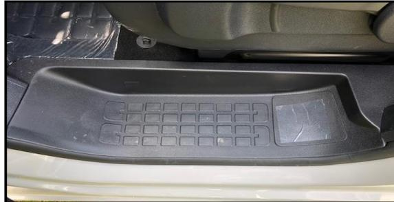
Desmontar la tapa del escalón en la talonera de la puerta delantera izquierda.
