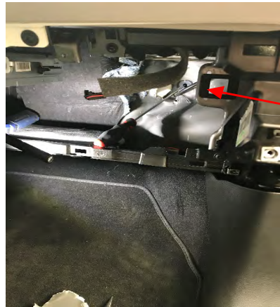
Fig. 1.7. Detalle paso cable de señal, detrás de la zona de la guantera, vista habitáculo
