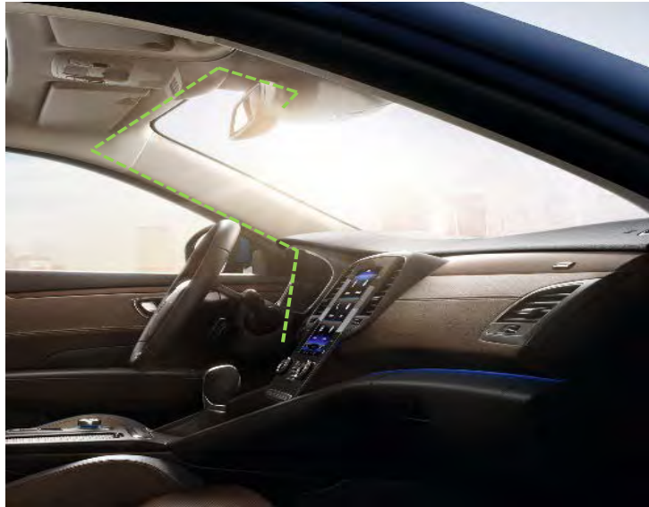
Fig. 4.6. Recorrido de los cables del taxímetro de espejo por el interior del guarnecido del techo.
