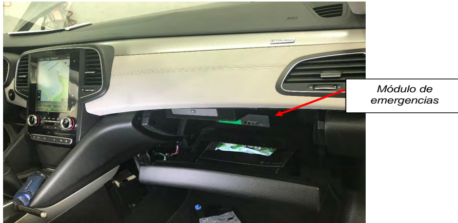
Fig. 7.1. Vista del emplazamiento del módulo de emergencias.
