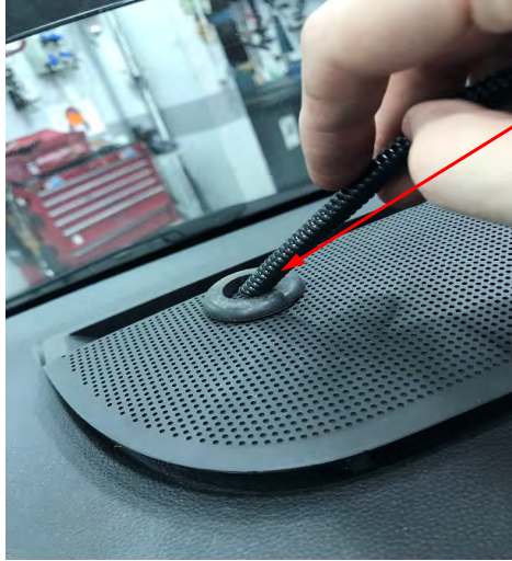
Fig. 4.3. Vista del paso de la manguera al habitáculo
