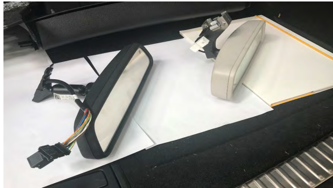
Fig. 5.3. Taxímetros de espejo y original del vehículo sustituido.
