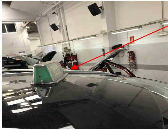
Fig. 6.1 Vista lateral del módulo atornillado
