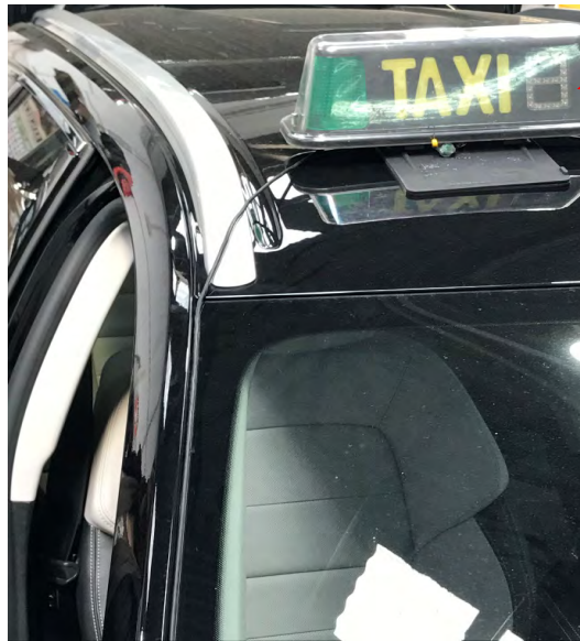
Fig. 6.4. Vista del módulo sobre soporte imantado
