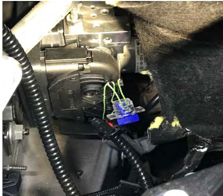
Fig. 1.6. Detalle del precintado del conector 1094 módulo ABS/ESP
