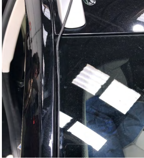
Fig. 6.5. Vistas del recorrido del cable por el marco del parabrisas
