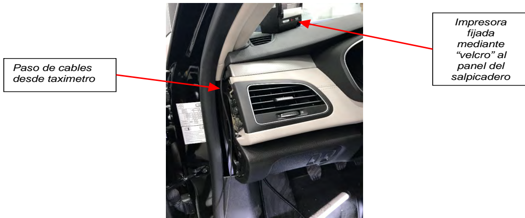
Fig. 5.6. Vistas de la disposición de la impresora y su conexión.
