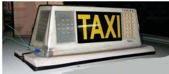
Fig. 6.3. Vista del módulo y su precinto
