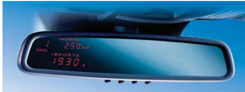
Taxímetro de espejo completamente integrado en el interior del espejo retrovisor original del vehículo. Éstos deben disponer y ser compatibles con impresoras periféricas.
