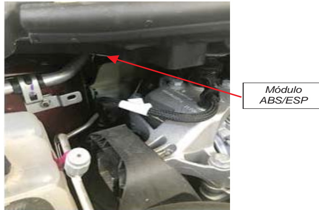
Fig. 1.1. Vista de la ubicación del módulo ABS/ESP en el compartimento motor
