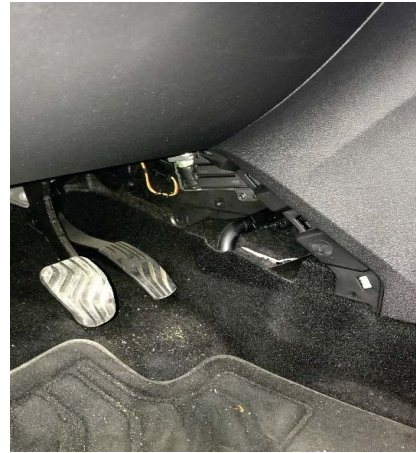
Fig. 3.1 y 3.2. Detalle paso de cables por la parte inferior del salpicadero central
