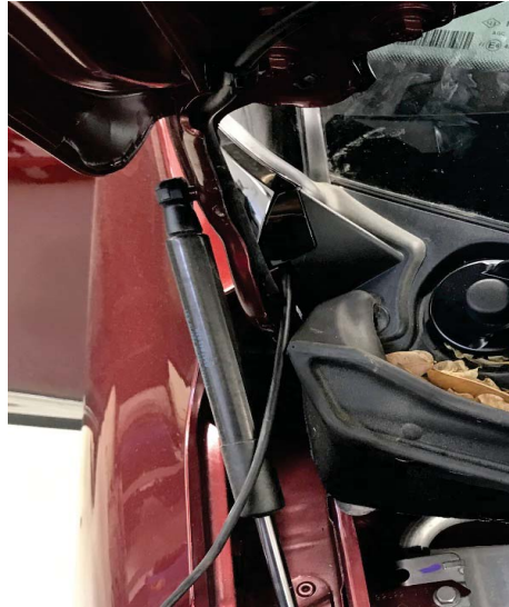
Fig. 6.5. Vista del paso de cable del módulo al compartimento motor
