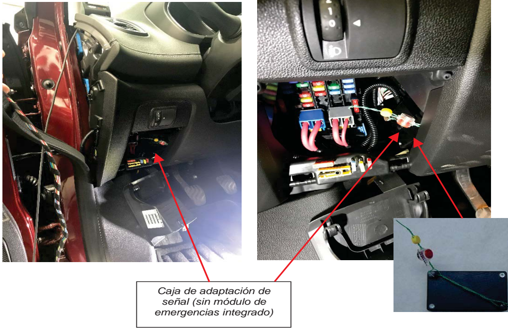
Fig. 3.4 y 3.5. Vistas del compartimento de fusibles con la caja adaptadora de señal y detalle del precinto.
