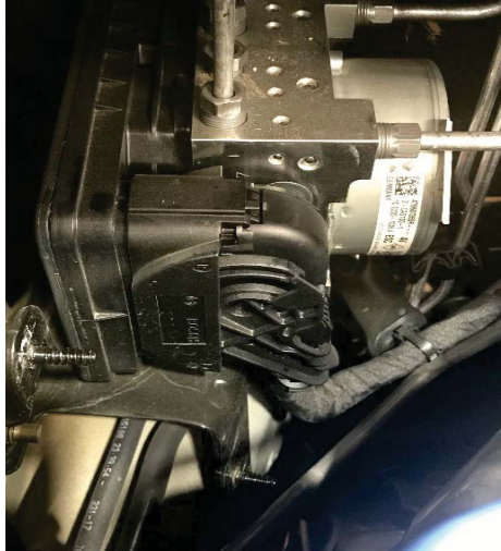
Fig. 1.3. Detalle conector 1094 módulo ABS/ESP
