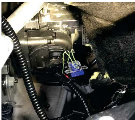
Fig. 1.6. Detalle del precintado del conector 1094 módulo ABS/ESP
