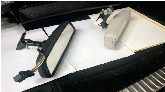
Fig. 5.1. Taxímetros de espejo y original del vehículo sustituido.
