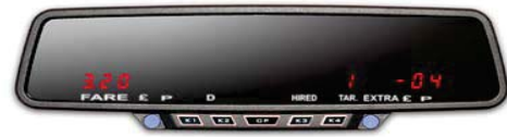
Taxímetro de espejo superpuesto al espejo original del vehículo. Éstos deben disponer y ser compatibles con impresoras periféricas.
