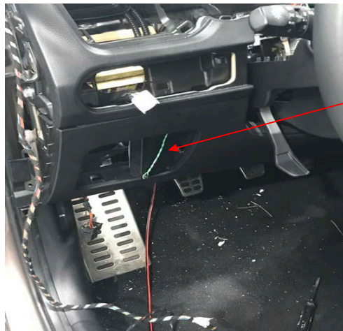
Fig. 1.6. Detalle del paso de manguera blindada al compartimento de la caja de fusibles.
