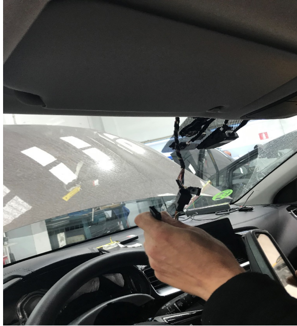
Fig. 4.4. Salida de cables para tax3metro de espejo
