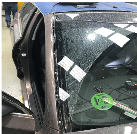
Fig. 6.5. Recorrido del cable del módulo por el exterior del marco del prabrisas
