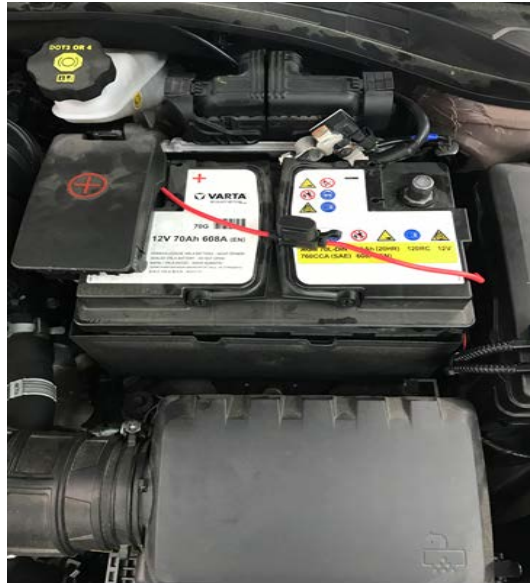
Fig. 2.1. Vista de las conexiones de alimentación a batería.
