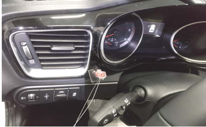
Fig. 1.7. Vista del precintado del cuadro de instrumentos.
