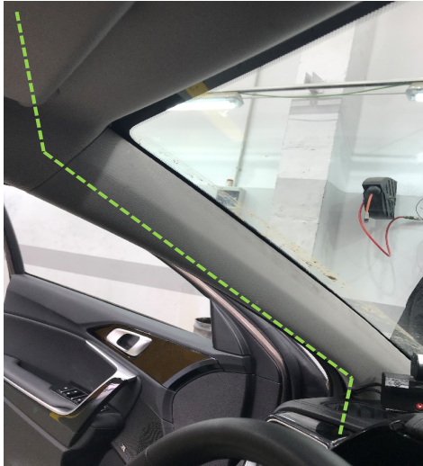
Fig. 6.2. Vista recorrido del cableado entre el módulo y la caja adaptadora de señal
