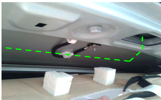
Fig. 10.1.2. Vista paso del cableado por el interior del techo
