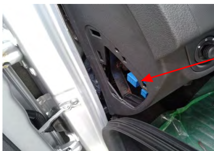
Fig. 4.1. Vista del paso de cables correspondiente a la toma de señal, salpicadero.
