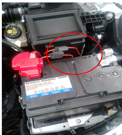
Fig. 2.1. Vista del fusible exterior
