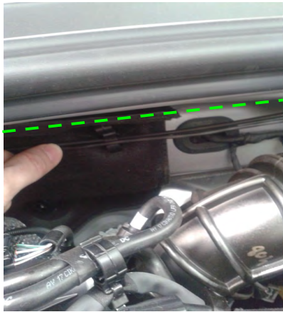
Fig. 10.2.3. Vista del paso de la manguera por el compartimento motor hacia el pasamuros
