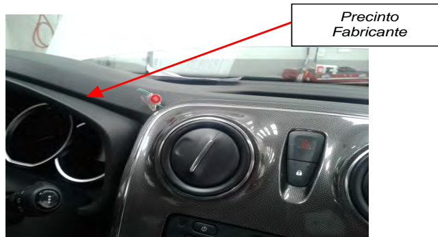
Fig. 3.1. Vista de la disposición del precintado de la consola central, Fabricante
