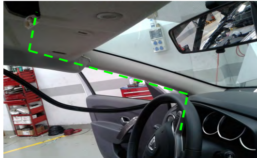
Fig. 10.1.3. Vista recorrido del cableado entre el módulo y la caja adaptadora de señal
