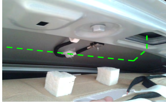
Fig. 10.1.2. Vista paso del cableado por el interior del techo
