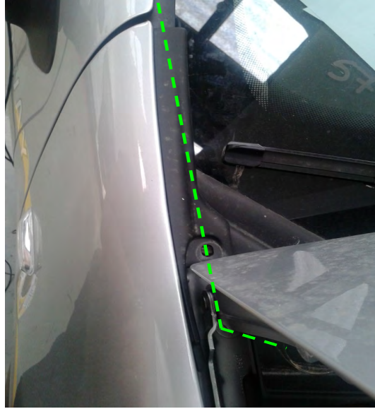
Fig. 10.2.2. Vista del paso de la manguera al compartimento motor
