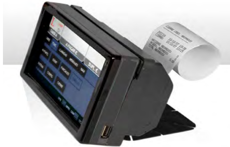
Taxímetro de tablero con monitor, impresora y terminal punto de venta en un solo módulo. Este tipo de taxímetro incluye otro módulo que corresponde al de emergencias y en el que se integra la caja adaptadora de señal.
