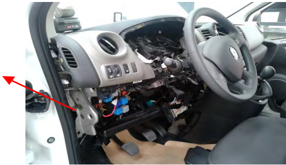
Fig. 1.5. Vista de la ubicación de la caja de fusibles
