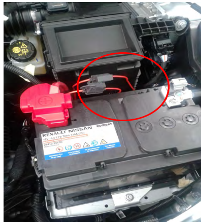
Fig. 2.1. Vista del fusible exterior
