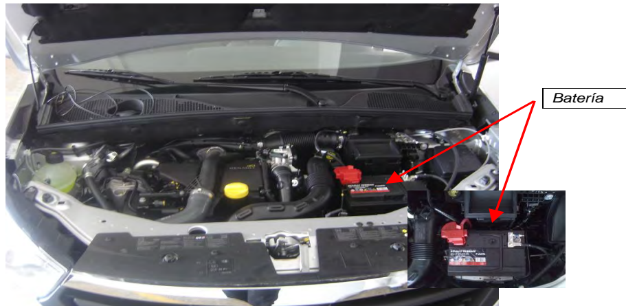
Fig. 1.3. Vista del alojamiento motor. Ubicación de la batería.
