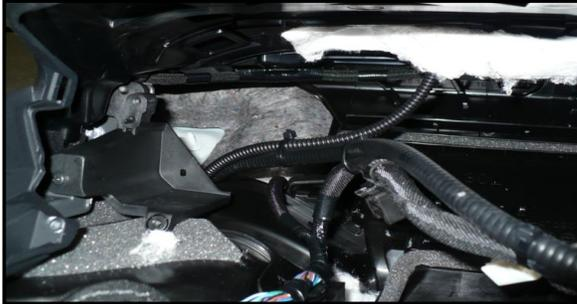
Cable baja por el lateral izquierdo del hueco de radio
