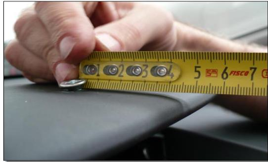
El soporte irá fijado con tornillos rosca-chapa y la distancia entre ambos variará en función del modelo de taxímetro.
