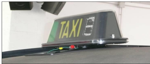
Ubicación del módulo luminoso
