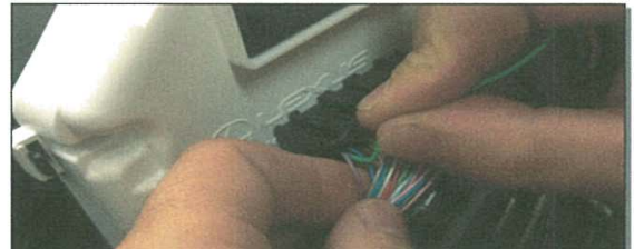
4.- Soldar cable taxímetro a la señal de velocidad
