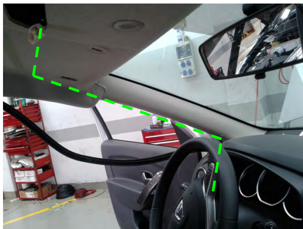
Fig. 10.1.3. Vista recorrido del cableado entre el módulo y la caja adaptadora de señal
