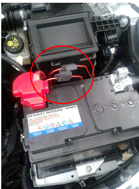
Fig. 2.1. Vista del fusible exterior
