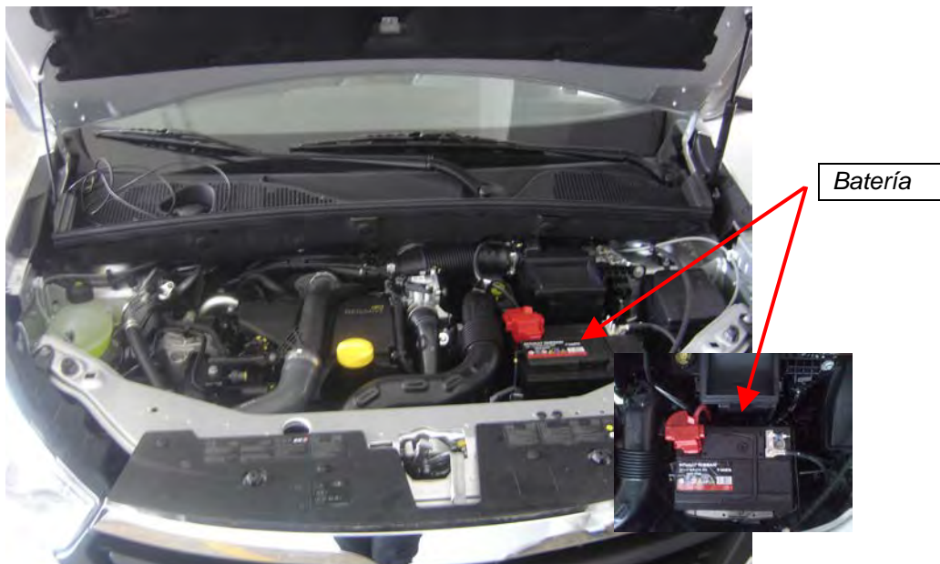
Fig. 1.3. Vista del alojamiento motor. Ubicación de la batería.
