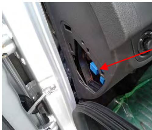
Fig. 4.1. Vista del paso de cables correspondiente a la toma de señal, salpicadero.
