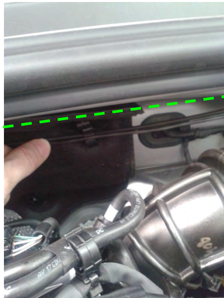
Fig. 10.2.3. Vista del paso de la manguera por el compartimento motor hacia el pasamuros
