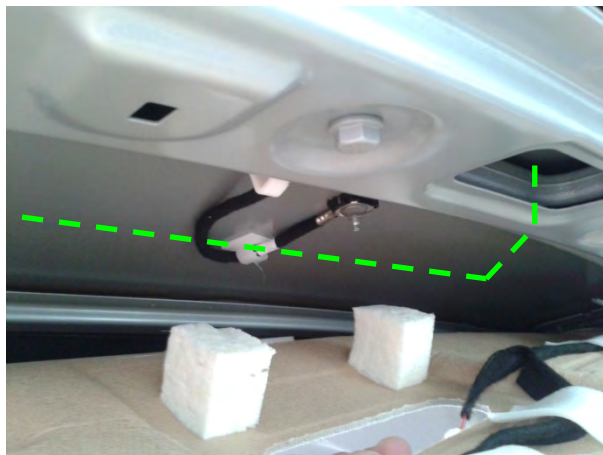
Fig. 10.1.2. Vista paso del cableado por el interior del techo
