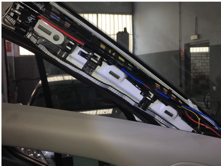
Del pilar A subirán hasta el guarnecido del techo por debajo de los parasoles hasta la posición de las luces de cortesía.
