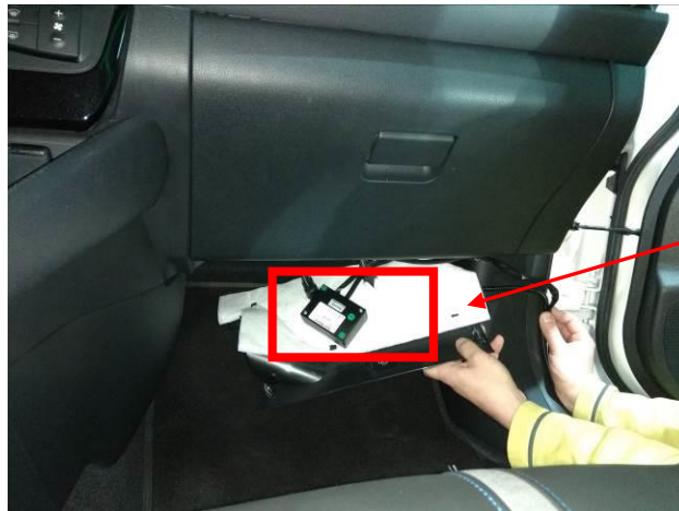
Situación de la caja de conexiones y la centralita del taxímetro
