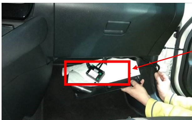
Situación de la caja de conexiones y la centralita del taxímetro
