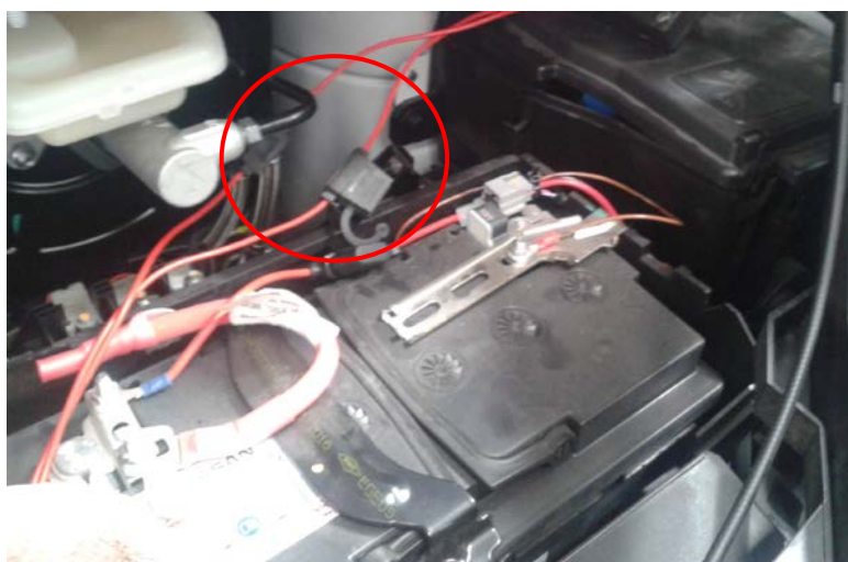
Fig. 4.1. Vista del fusible exterior
