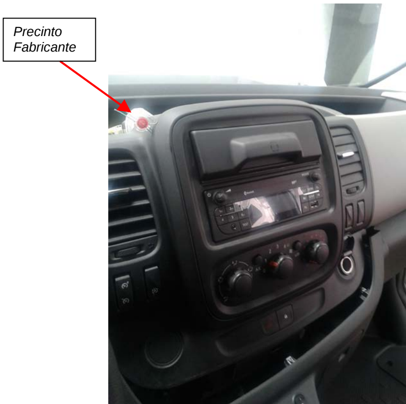
Fig. 3.1. Vista de la disposición del precintado de la consola central por parte de la marca
