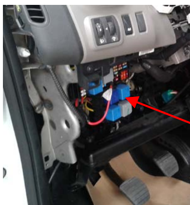
Fig. 4.1. Vista del paso de cable de señal por el salpicadero
