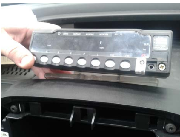
Fig. 7.1. Detalles de la sujeción del soporte y del taxímetro.
