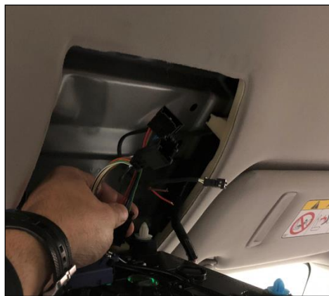
Cableado y conectores para taxímetro de espejo y capilla
