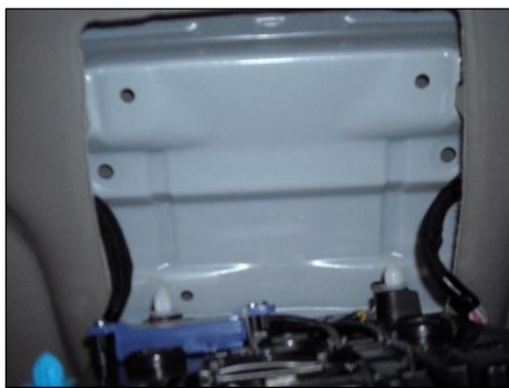
Detalle del hueco de luces de techo y pletina con tornillos y cable de la capilla
