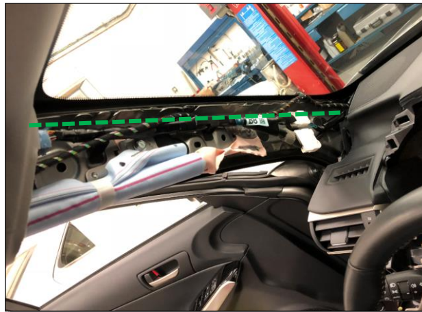
Recorrido del cable del módulo tarifario
