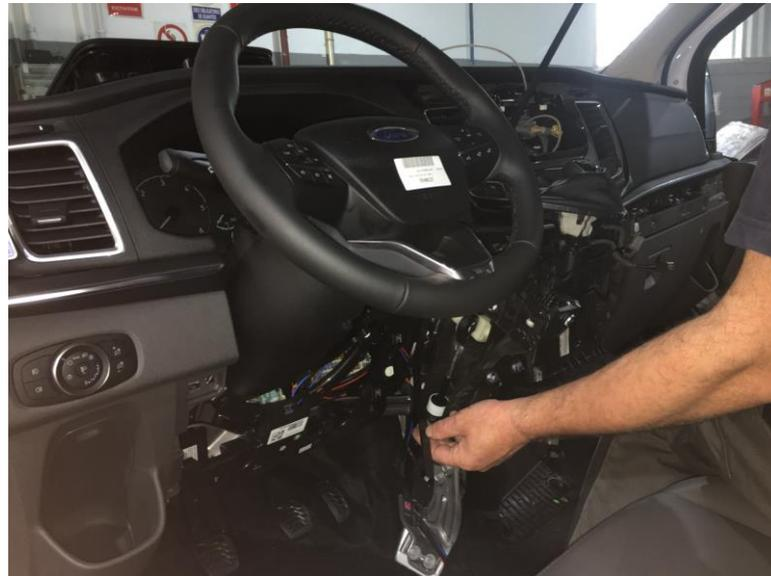
El uso de esta guía nos permitirá el paso de los cables del taxímetro desde el aparato a las tomas de la preinstalación del fabricante y de la manguera blindada a la parte superior del Salpicadero.
