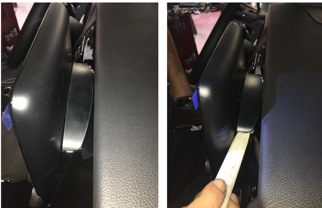
Desmontaje de la tapa superior con el uso de una espátula
