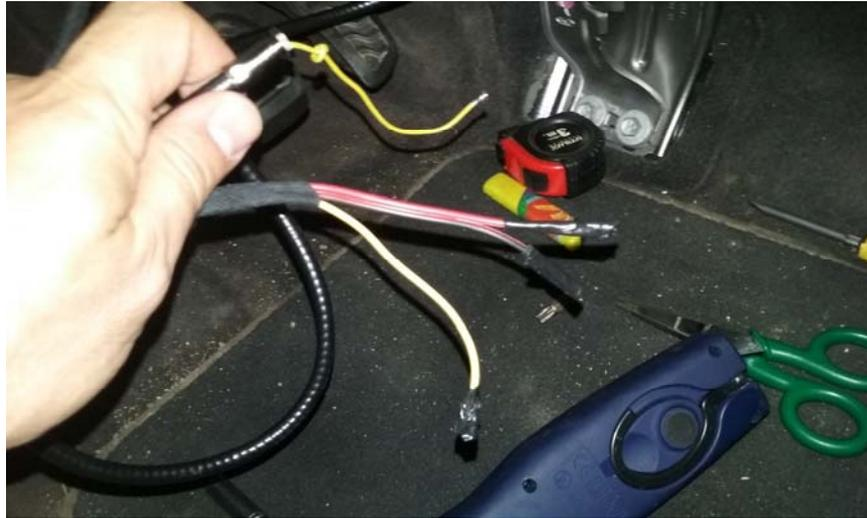
Por un lado la manguera blindada de toma de "señal de velocidad" para taxímetro y por otro la toma de "Masa" y las tomas de "Contacto, Bajo Llave o 15" y de "Positivo Directo" que recordemos tenían incorporado un fusible de 6 Amperios y que han quedado en la zona del alojamiento de las baterías.
