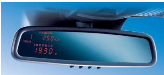
**Taxímetro de espejo completamente integrado en el interior del espejo retrovisor original del vehículo o superpuesto.** Éstos deben disponer y ser compatibles con impresoras periféricas.
