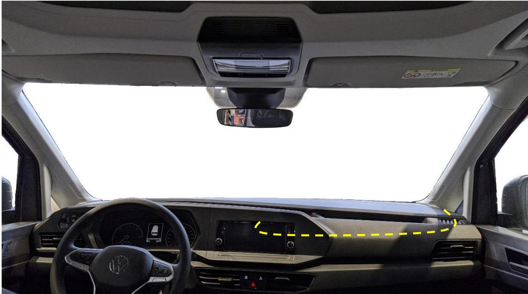
Figura 22. Trazado de la manguera con módulo tarifario en la derecha.
