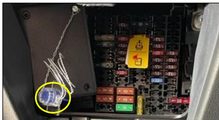
Figura 18. Precinto caja de conexiones.
