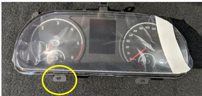
Figura 13. Ubicación tornillo a sustituir.
