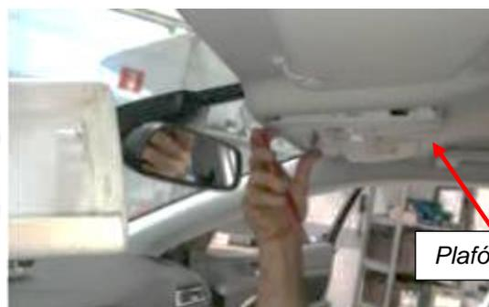
Para el montaje del conjunto luminoso es necesario practicar tres orificios (dos para atornillar el módulo, de  $\varnothing 7$  mm, y el otro centrado para la conducción eléctrica, de  $\varnothing 16$  mm) en el techo del vehículo. El módulo tarifario irá situado aproximadamente a 400 mm del parabrisas.
