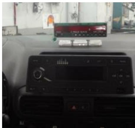
El cableado del taxímetro discurrirá desde la caja de conexiones, zona VSM (antigua BSI), hasta la conexión con el taxímetro de salpicadero, a través del interior del salpicadero para lo cual usaremos una guía pasacables y si fuera necesario se extraería el cuadro de instrumentos del vehículo.
