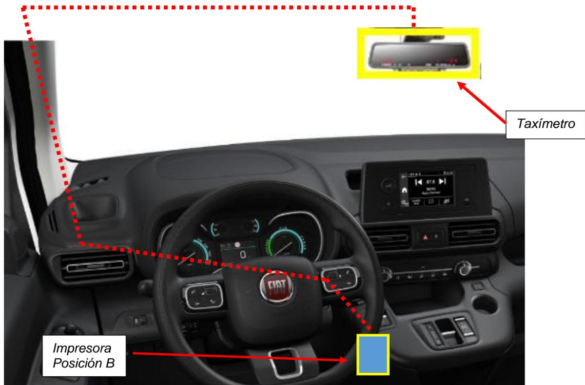
**IMPORTANTE:** El mazo de conexiones de la impresora deberá discurrir por el interior de guarnecido del pilar A siempre por encima del módulo de airbag lateral y asegurando la no interferencia del mismo con la zona de despliegue del airbag.
