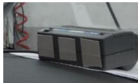
La conexión de la **impresora con taxímetro de tablero en el módulo central (Posición B)**, la realizamos directamente desde el Taxímetro. La impresora se fijará con velcro al lateral del módulo central.
