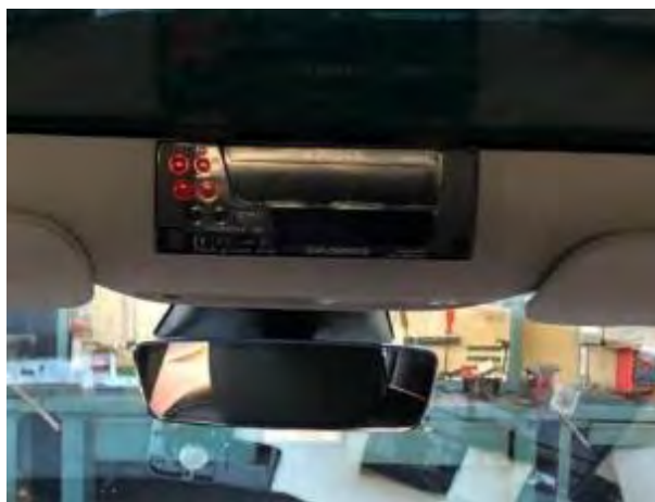
Fig. 8. Vista de un taxímetro de consola en la ubicación prevista en el techo.
