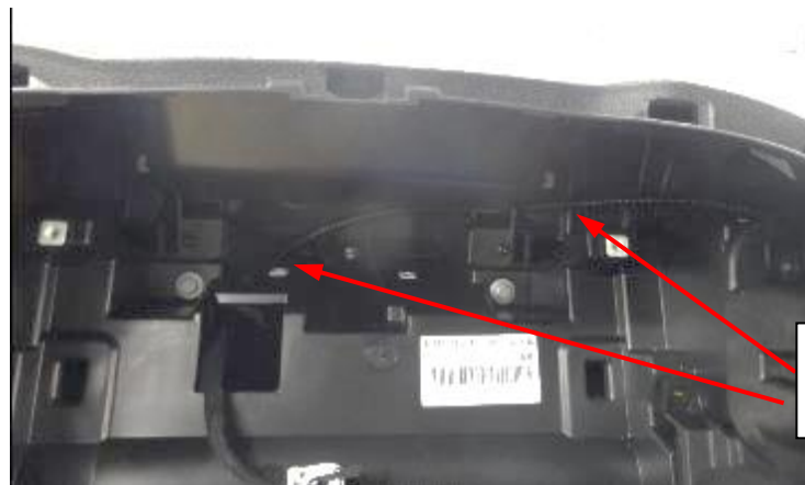
Cableado para Taxímetro a través de cuadro de instrumentos
