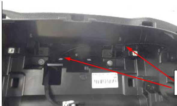
Tornillos para extracción de cuadro de instrumentos
