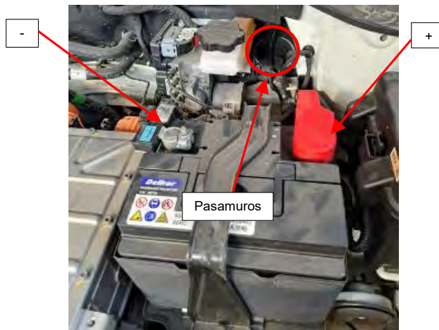
Fig. 4.1. Disposición de bornes de batería y pasamuros.
