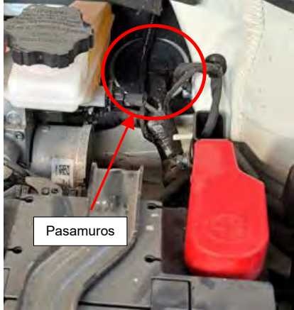
Fig. 2.1. Detalle pasamuros desde compartimento motor.
