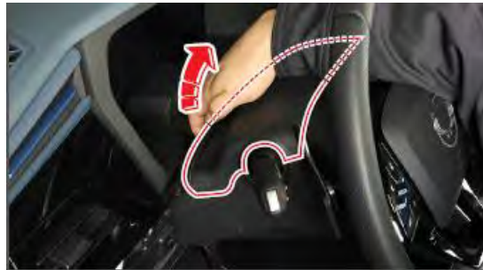
Fig. 1.2. Detalle extracción guarnecido superior del volante.
