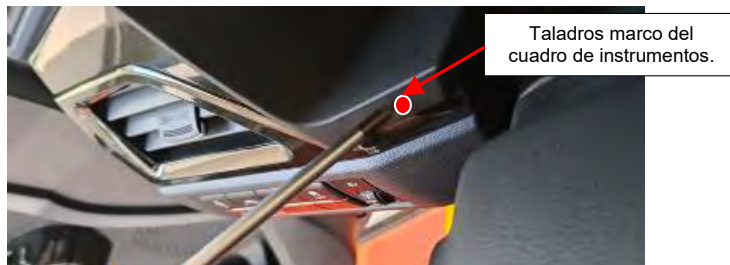
Fig. 3.2. Taladros precintado cuadro de instrumentos.
