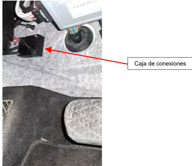
Fig. 3.1. Zona instalación caja de conexiones.
