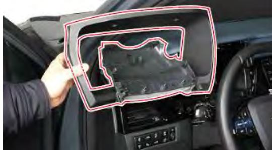
Fig. 1.3. Detalle extracción marco cuadro de instrumentos.
