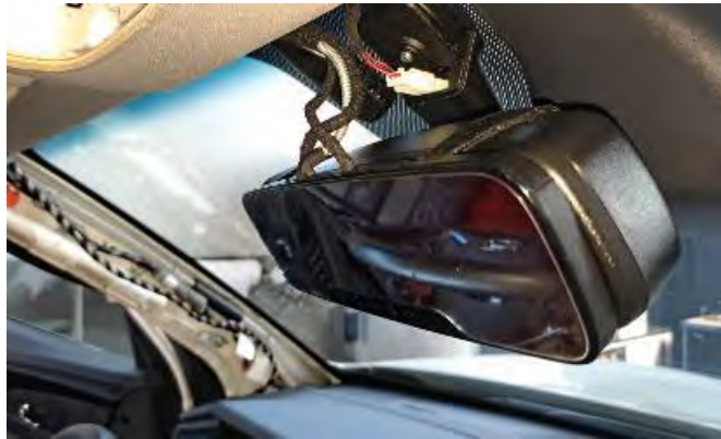
Fig. 4.2.3. Taxímetro de espejo superpuesto instalado.
