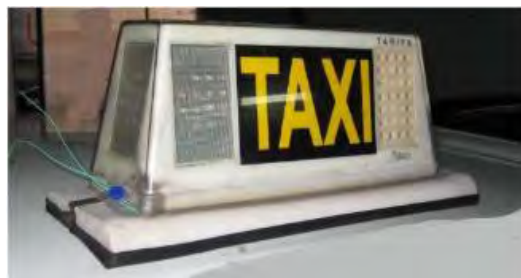
Fig. 6.3. Vista del módulo y su precinto
