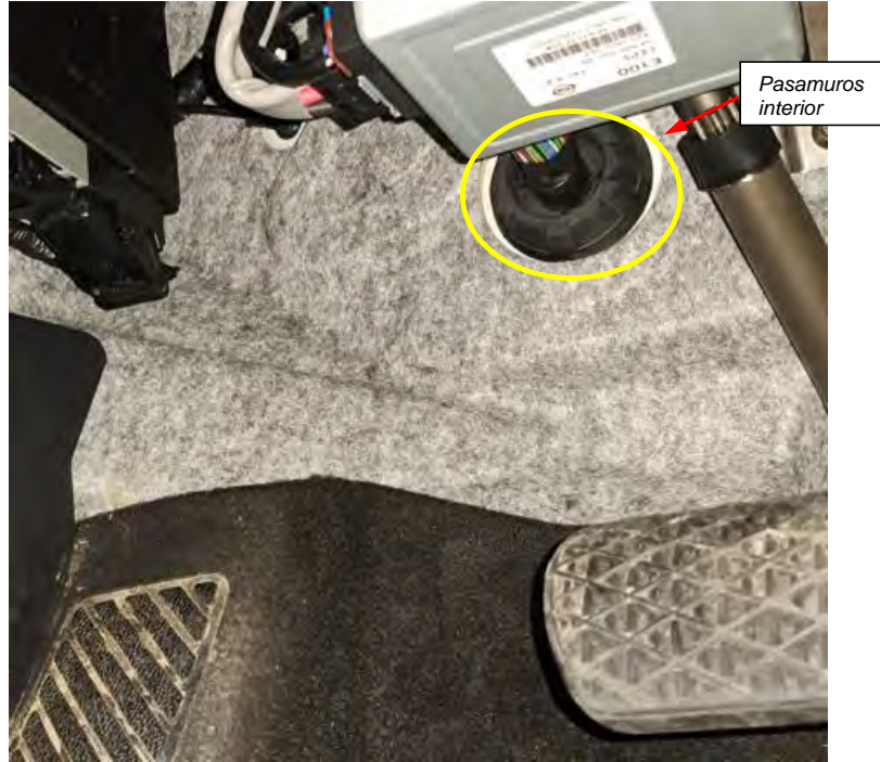
Fig. 6.2.6. Ubicación y detalle de pasamuros sobre los pedales desde el habitáculo interior.
