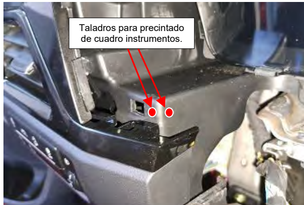
Fig. 3.1. Taladros precintado cuadro de instrumentos.
