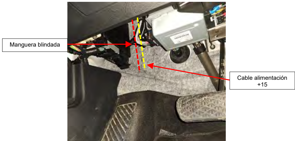
Fig. 2.2. Zona donde se dejará el cable de alimentación bajo llave +15.
