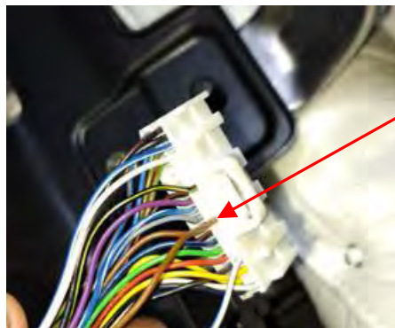
Fig. 2.1. Detalle cable pin 12 de señal de velocidad
