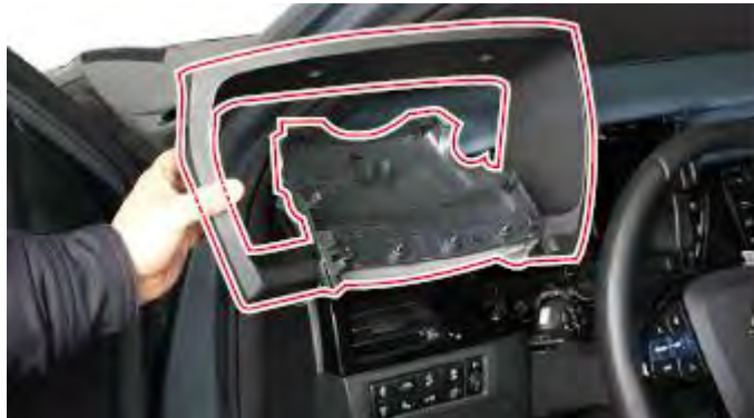
Fig. 1.3. Detalle extracción marco cuadro de instrumentos.
