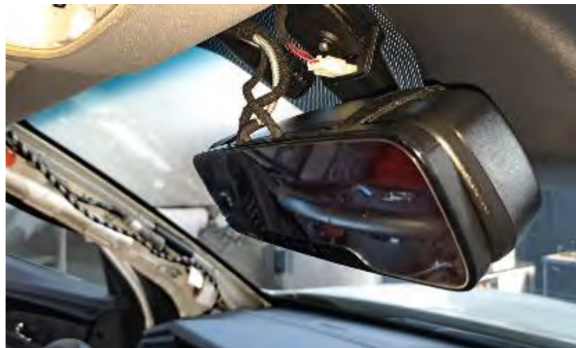
Fig. 4.2.3. Taxímetro de espejo superpuesto instalado.
