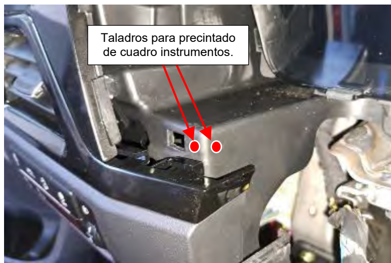
Fig. 3.1. Taladros precintado cuadro de instrumentos.
