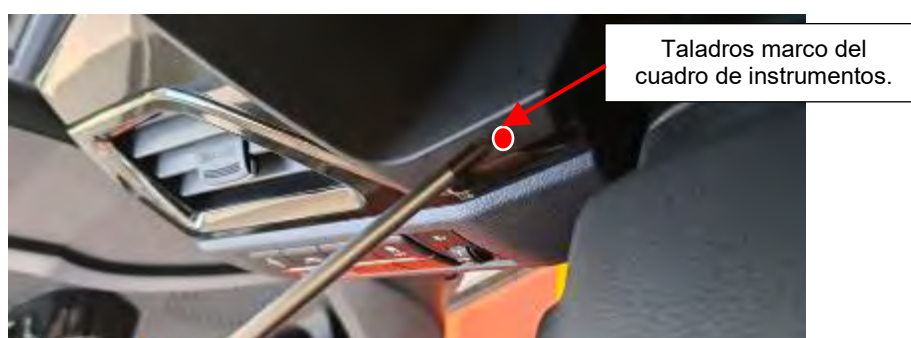
Fig. 3.2. Taladros precintado cuadro de instrumentos.
