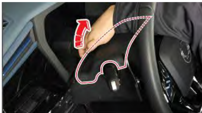
Fig. 1.2. Detalle extracción guarnecido superior del volante.
