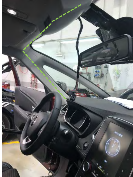
Fig. 4.1.4. Recorrido de los cables por el interior del guarnecido del techo
