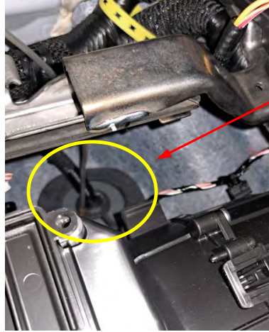
Fig. 6.2.6. Ubicación y detalle de pasamuros tras la guanterera del pasajero desde el habitáculo interior.
