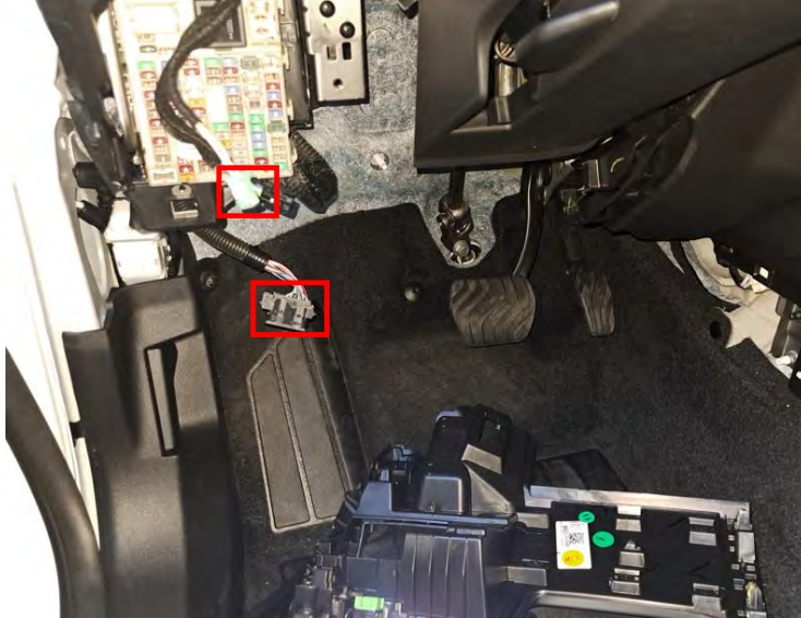
Fig. 2.4. Detalle conectores y tapa inferior retirada.
