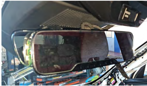
Fig. 4.4. Taxímetro de espejo superpuesto instalado.
