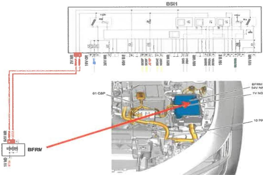
Una vez realizada la conexión de positivo con sus correspondientes fusibles, llevaremos un positivo y un negativo de batería hasta la caja adaptadora de señal situada en la zona de la BSI bajo volante lado conductor.
