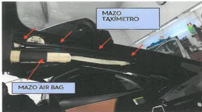
Finalmente, el mazo completo del taxímetro se lleva hasta la BSI por el lateral del salpicadero, donde se conectará con la caja adaptadora de señal del instalador, con su precinto correspondiente.
