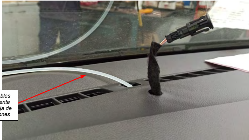
Fig. 4.3. Vista del paso de la manguera a la zona superior del salpicadero.
