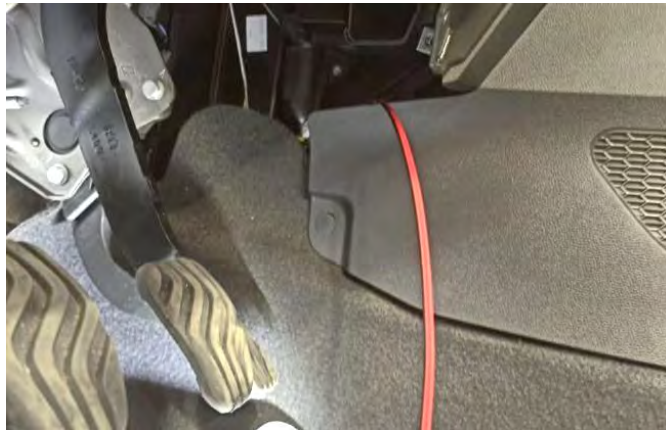
Fig. 7.3 y 7.4. Recorrido de la manguera del módulo de emergencias.
