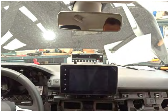
Fig. 4.1.1.3. Vista posterior de taxímetro consola sobre salpicadero.
