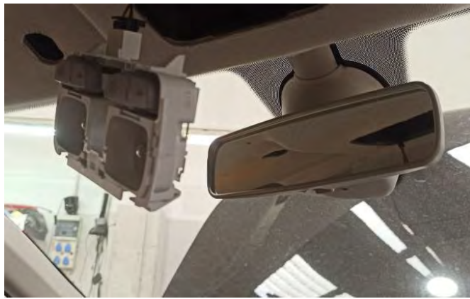
Fig. 4.2.1.1. Vista del plafón desmontado y del retrovisor original.
