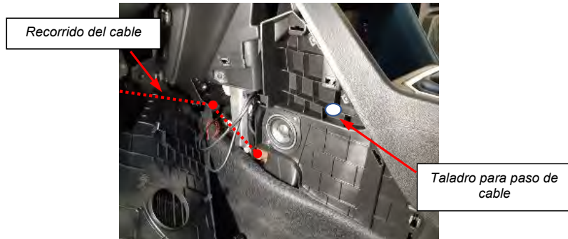
Fig. 5.2.2. Recorrido cable impresora hueco portaobjetos central.
