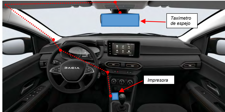
5.2.1. Recorrido cable de taxímetro de espejo.
