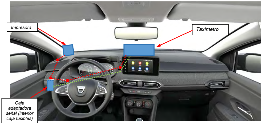
Fig. 4.1. Esquema orientativo del recorrido de las conexiones para taxímetros sobre salpicadero .
