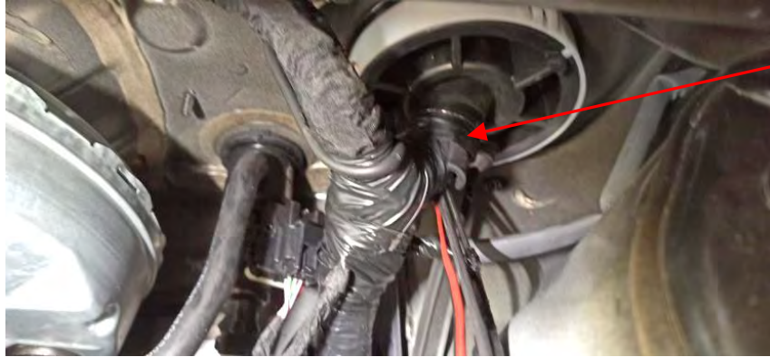
Fig. 2.2. Detalle pasamuros, vista compartimento motor
