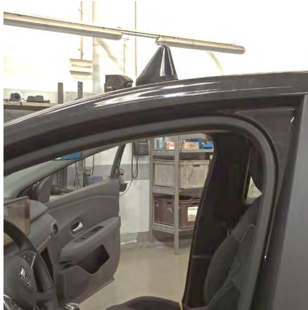
Fig. 6.2. Vista lateral ejemplo módulo centrado atornillado
