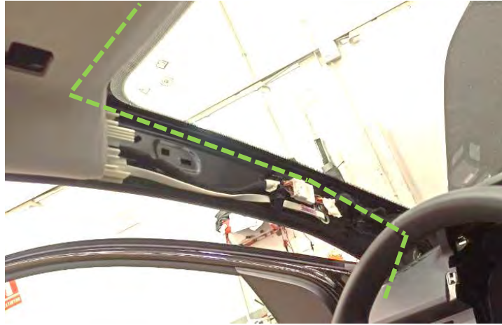
Fig. 4.2.4. Recorrido de los cables por el interior del guarnecido del marco del parabrisas.
