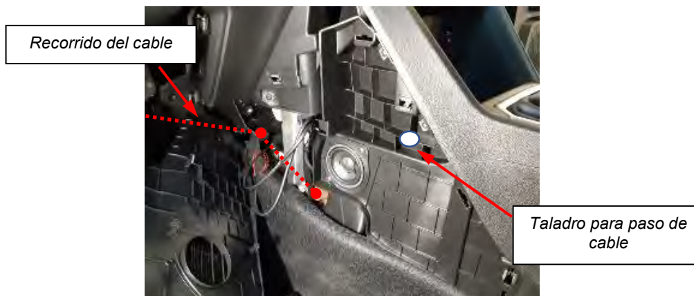
Fig. 5.2.2. Recorrido cable impresora hueco portaobjetos central.
