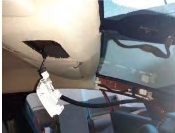
Fig. 4.2.2. Vista del plafón desmontado.
