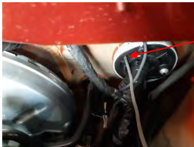
Fig. 2.2. Detalle pasamuros, vista compartimento motor
