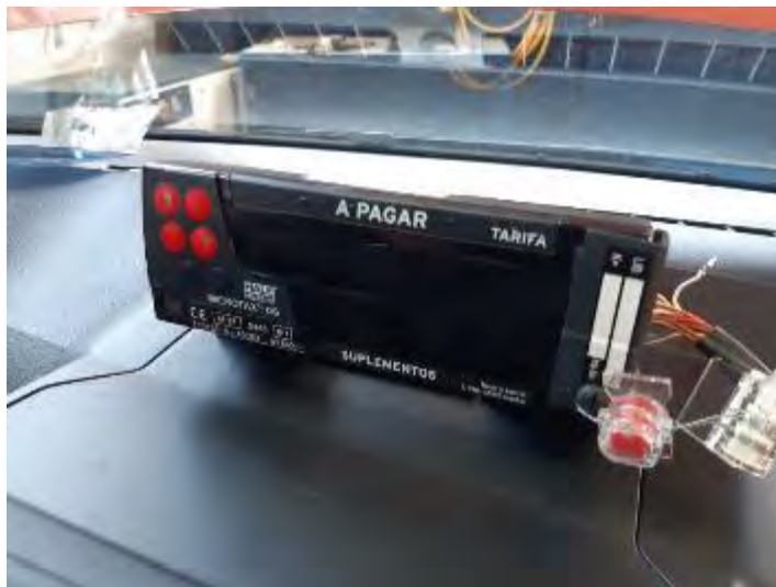
Fig. 4.1.1.1. Ubicación de taxímetro consola sobre salpicadero sin pantalla.
