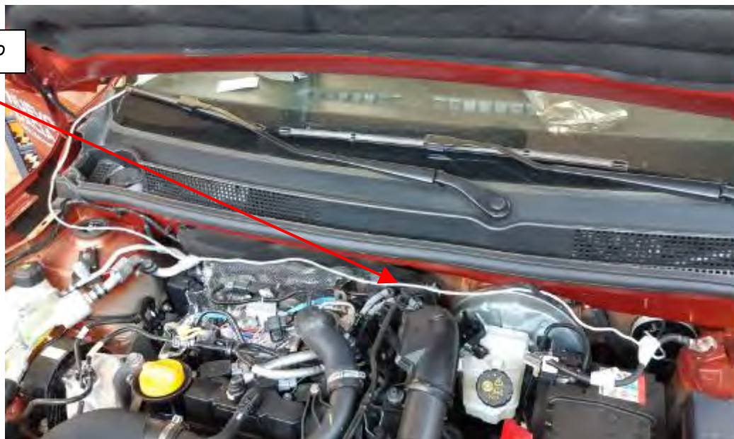
Fig. 6.6 Vista del recorrido del cable módulo luminoso por el cofre motor
