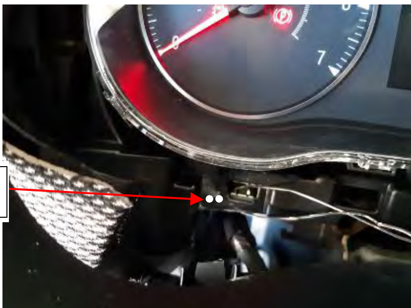
Fig. 2.4. Identificación del punto de amarre del alambre del precinto.
