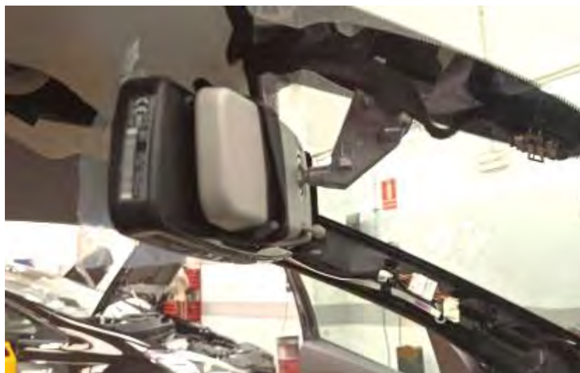
Fig. 4.2.4. Vista de taxímetro de espejo superpuesto.
