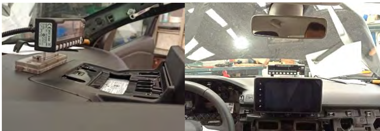
Fig. 4.1.1.3. Vista Taxímetro en vehículos con pantalla integrada.
