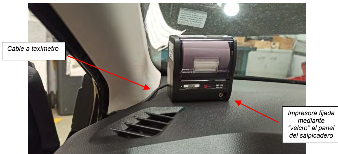
Fig. 5.1.1 Vistas impresora extremo izquierdo delantero del interior del habitáculo, junto al marco del parabrisas.
