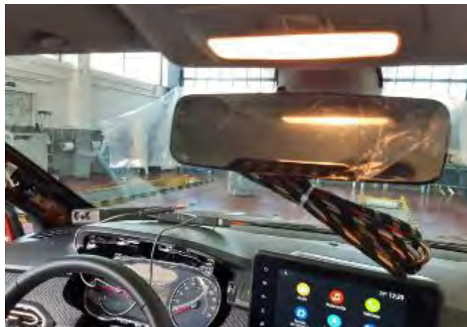
Fig. 4.2.3. Vista del taxímetro de espejo
