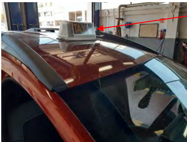
Fig. 6.1. Vista frontal ejemplo módulo centrado atornillado
