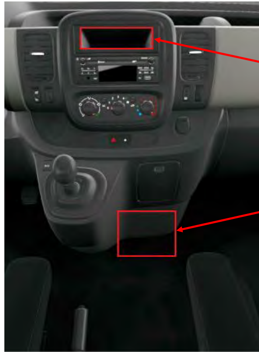
Fig. 10.2. Vista de los posibles emplazamientos de la emisora de radio
