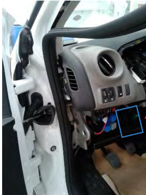
Fig. 3.1. Vista de la caja de fusibles, donde irá emplazada la caja conversor-adaptador.
