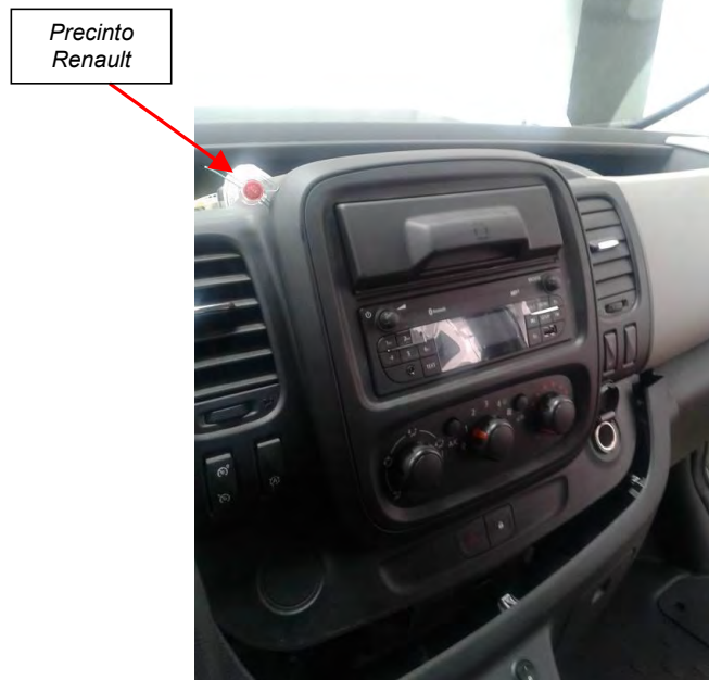
Fig. 3.1. Vista de la disposición del precintado de la parte central del salpicadero por parte de la marca
