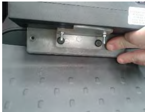
Fig. 6.1. 6.2 y 6.3. Detalles de la sujeción del soporte y del taxímetro de consola.
