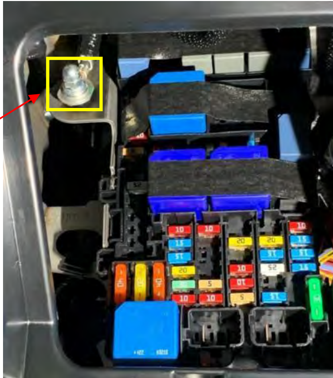
Fig. 2.4. Detalle de conexión negativo de masa a chasis.
