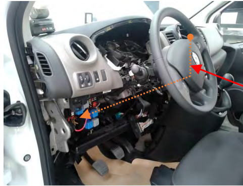
Paso cableado por el salpicadero hasta caja de fusibles
