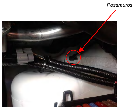
Fig. 1.4. Vista de la ubicación del pasamuros.
