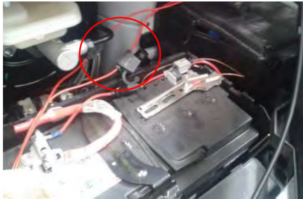
Fig. 2.1. Vista del fusible exterior
