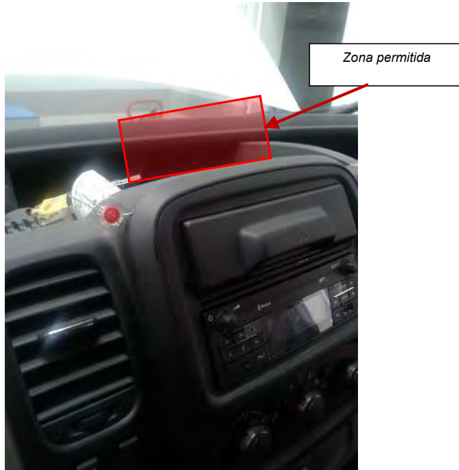
Fig. 5.1. Vista de la zona permitida para la instalación del taxímetro de consola
