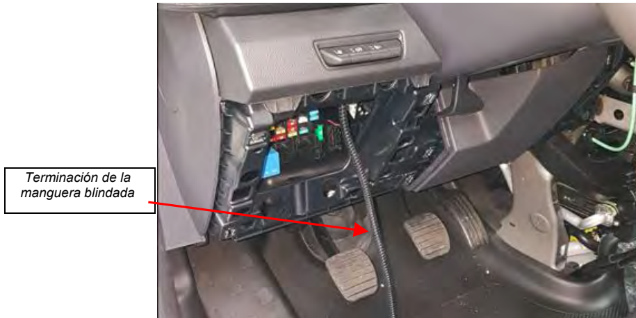
Fig. 3.2.1. Vista de la terminación de la manguera blindada puesta por el concesionario
