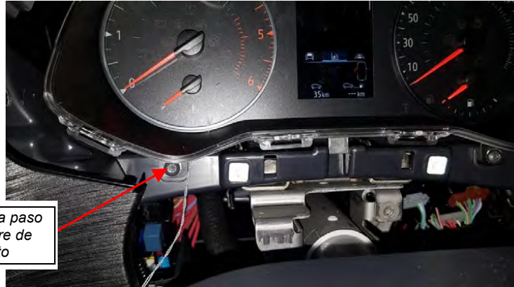
Fig. 3.1. Paso de alambre corrugado por el bastidor del cuadro.
