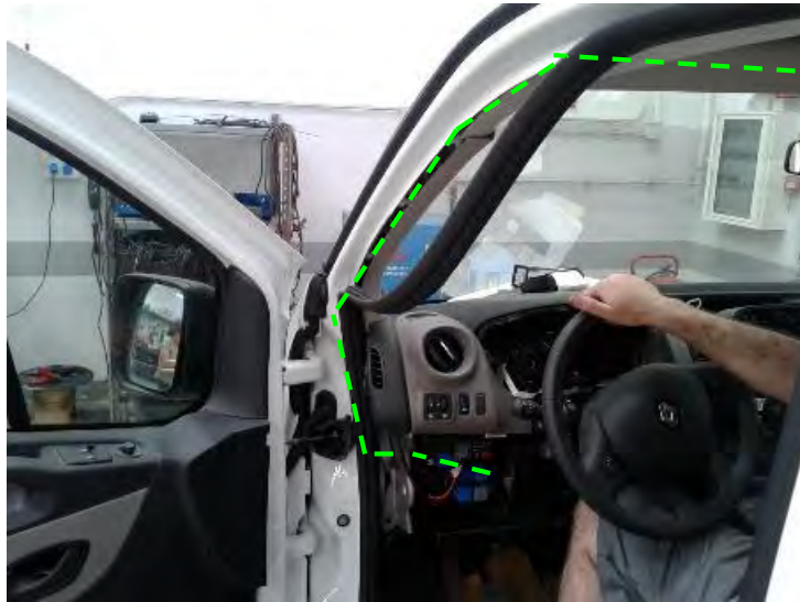
Fig. 8.3. Recorrido de las conexiones al taxímetro de espejo.
