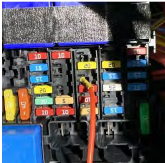
Fig. 2.3. Detalle de La conexión a fusible N° 17
