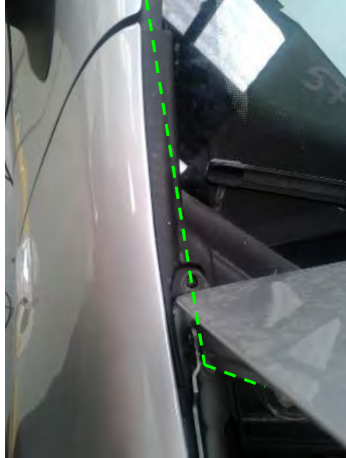
Fig. 9.2.2. Vista del paso de la manguera al compartimento motor
