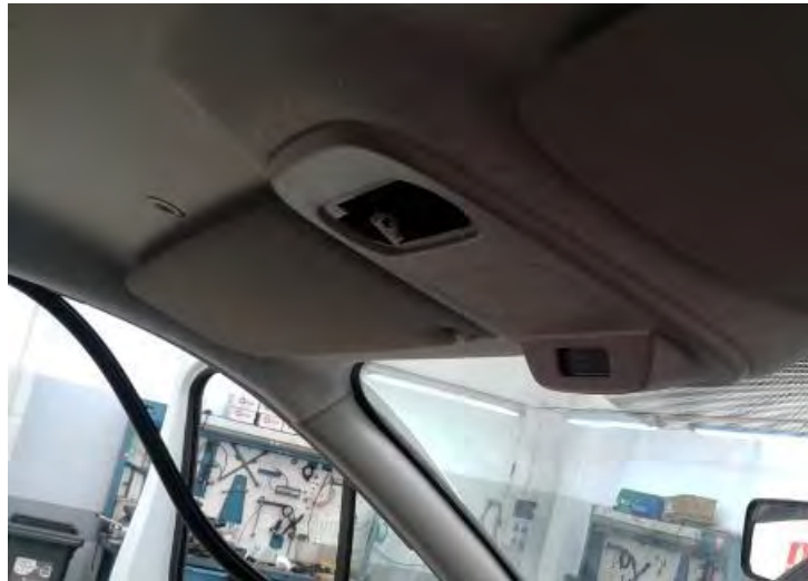
Fig. 9.1.1. Vista del acceso al techo por le plafón superior.
