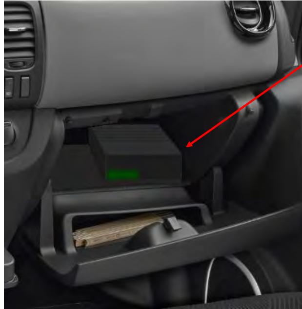
Fig. 10.1. Vista del emplazamiento del módulo de emergencias.
