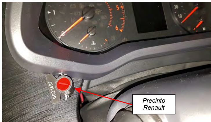
Fig. 3.4. Vista de la disposición final del precintado del cuadro de instrumentos
