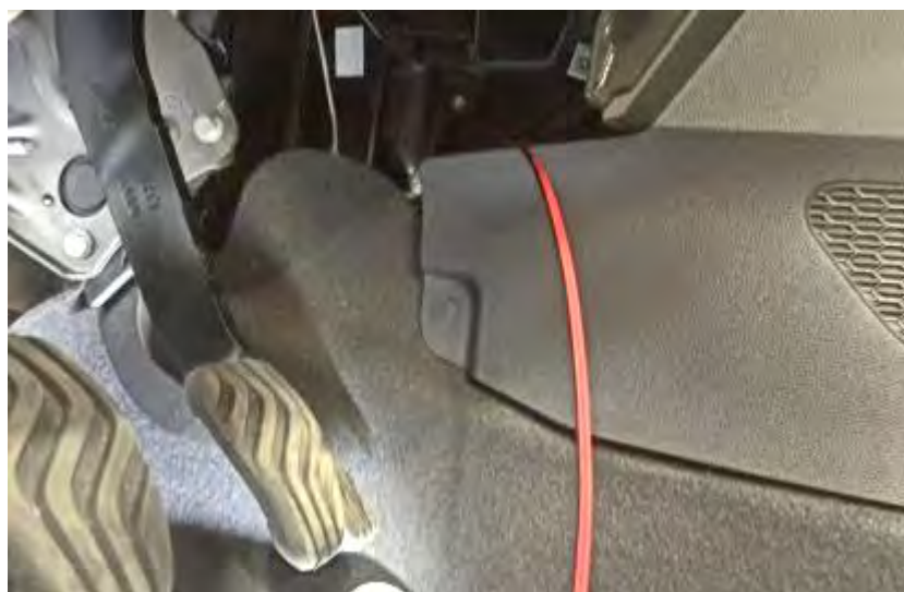
Fig. 7.3 y 7.4. Recorrido de la manguera del módulo de emergencias.
