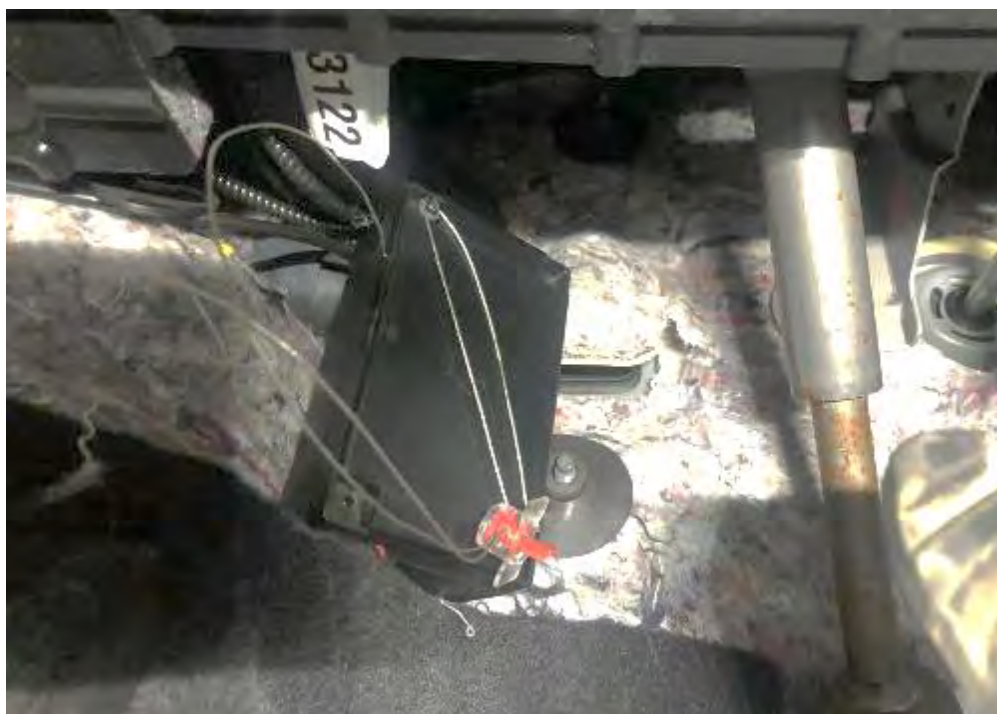
Fig. 3.1.4. Vista de la caja de conexiones precintada e instalada con velcro encima del reposapiés
