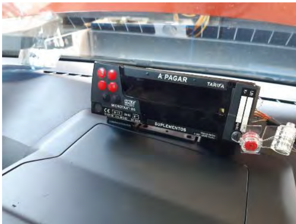
Fig. 4.3. Vista taxímetro instalado.
