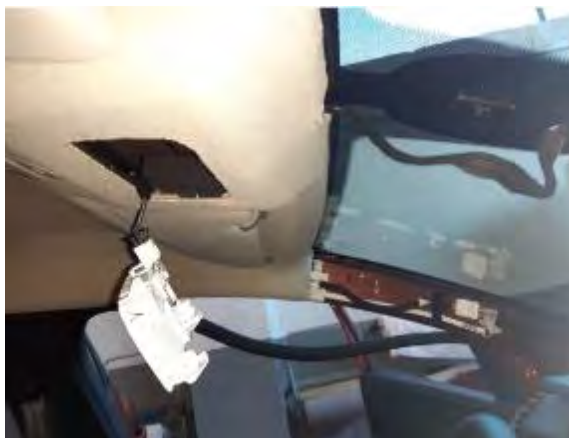
Fig. 5.4. Vista del plafón desmontado.
