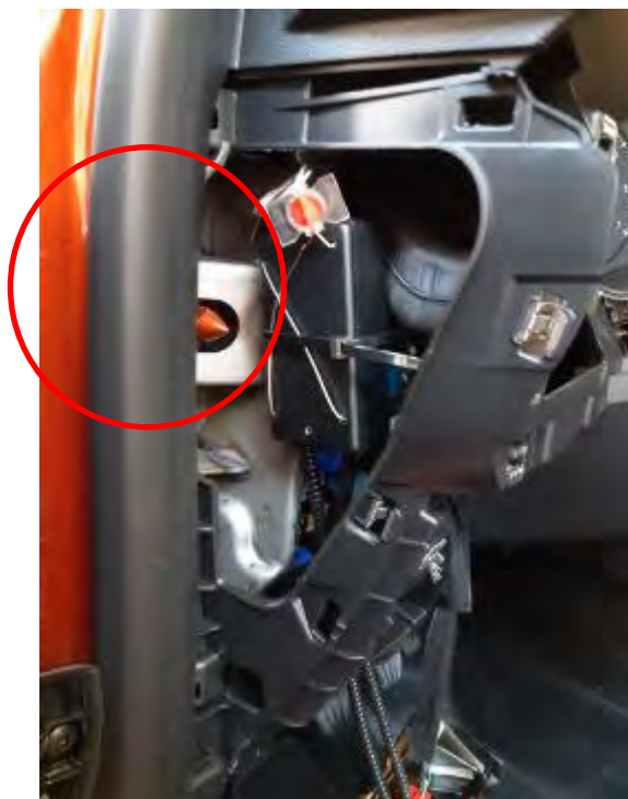
Fig. 4.6. Zona de paso del cableado
