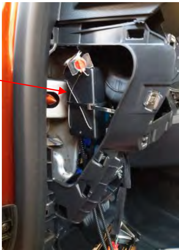
Fig. 3.3. Vista del compartimento lateral con la caja adaptadora de señal y detalle de precintos.
