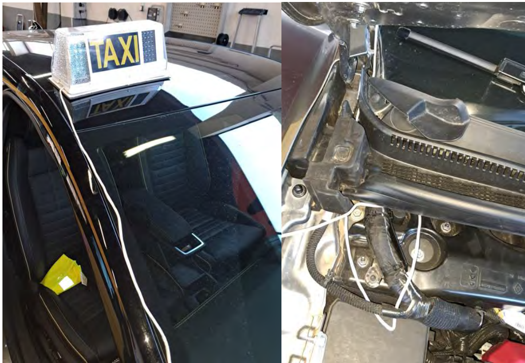
Fig. 6.2.4. Recorrido de los cables por vierteaguas del pilar A derecho.
