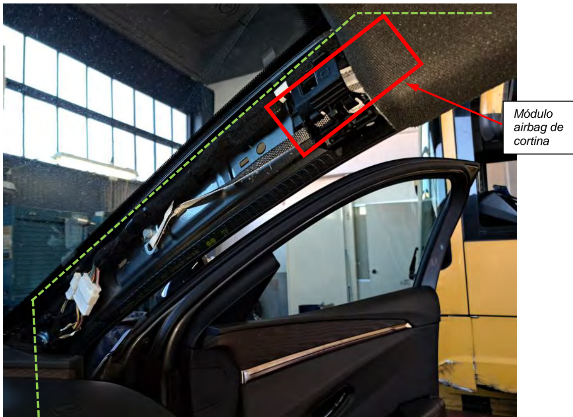
Fig. 6.2.3. Recorrido de los cables por el interior pilar A derecho.
