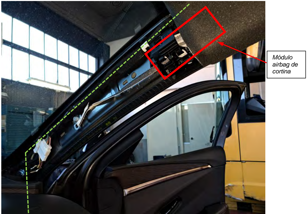
Fig. 4.2. Recorrido de los cables por el interior pilar A derecho.
