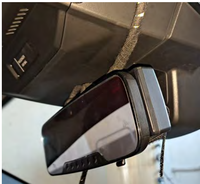
Fig. 4.4. Taxímetro de espejo superpuesto instalado.
