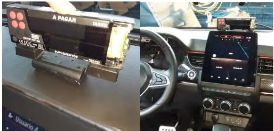
Fig. 5.1.1 y 5.1.2. Ubicación taxímetro consola con soporte sobre salpicadero.
