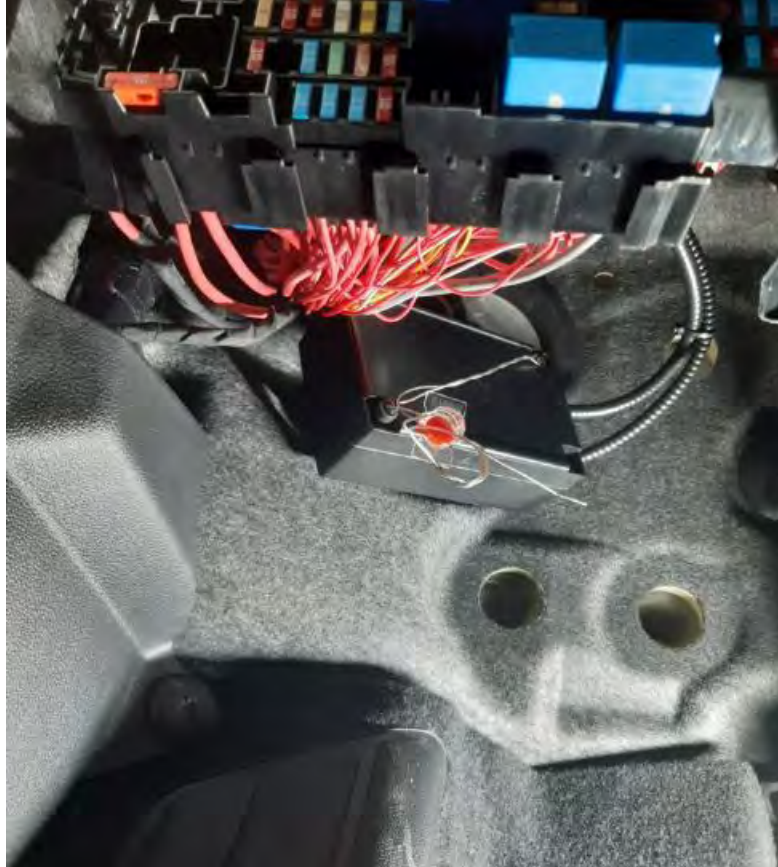
Fig. 3.4. Vista del de la caja de conexiones precintada e instalada con velcro encima del reposapiés, bajo el salpicadero
