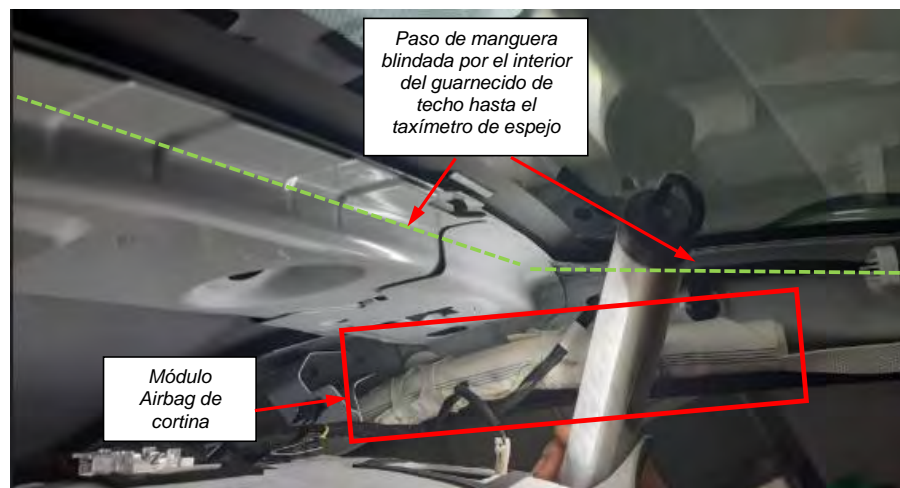
Fig. 4.2.3. Recorrido manguera blindada por guarnecido de techo.
