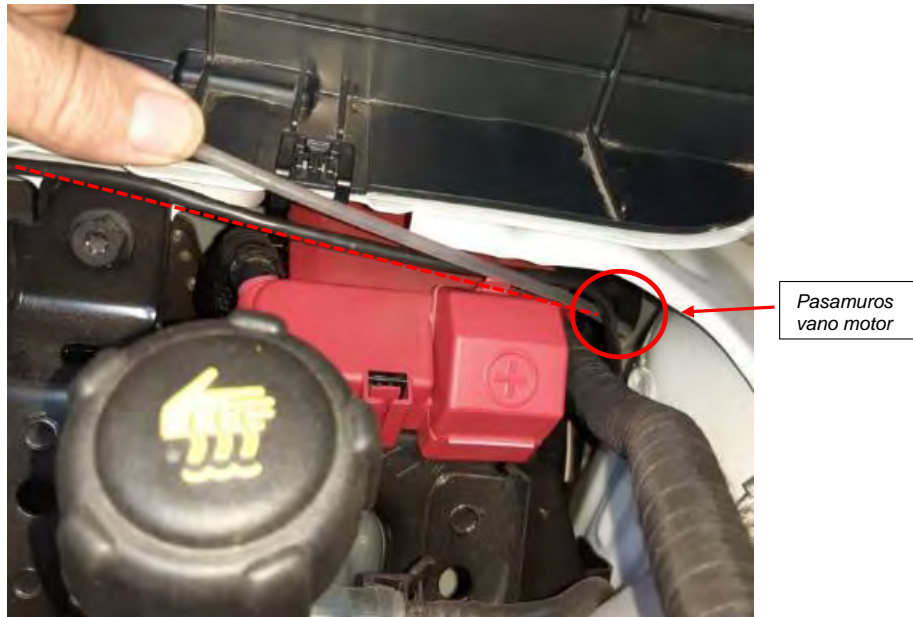
Fig. 6.2.4. Vistas del paso de cable del módulo a través del pasamuros.
