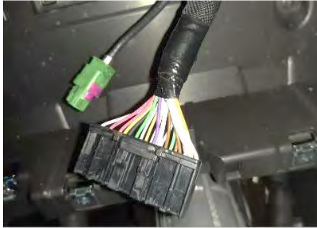
Fig. 1.3. Vista del conector 247 del cuadro de instrumentos
