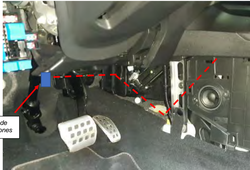
Fig. 7.3. Recorrido de las conexiones para el módulo de emergencia
