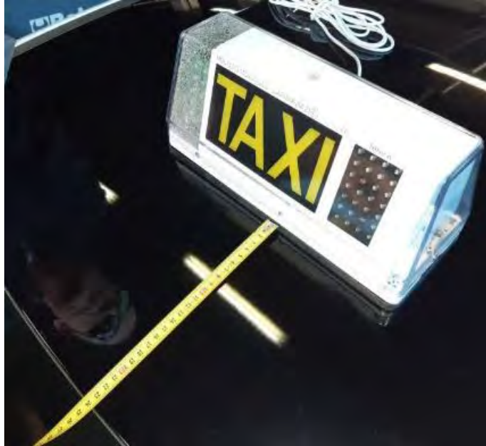
Fig. 6.1.2. Vista del módulo atornillado a 240 mm del parabrisas.
