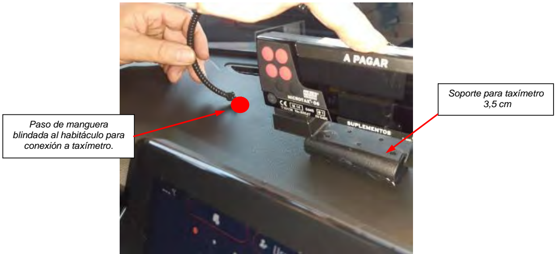
Fig. 4.1.3. Vista del paso de la manguera al habitáculo
