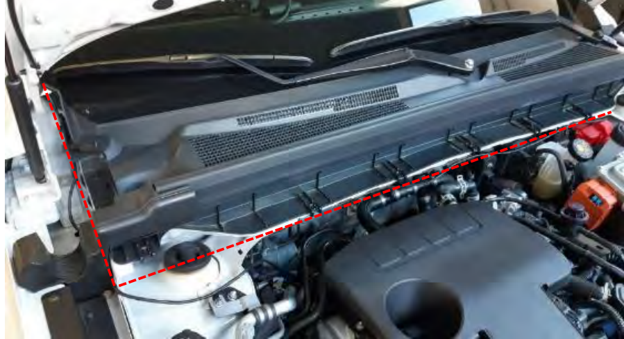
Fig. 6.2.3. Vistas del paso de cable del módulo a través del compartimento motor
