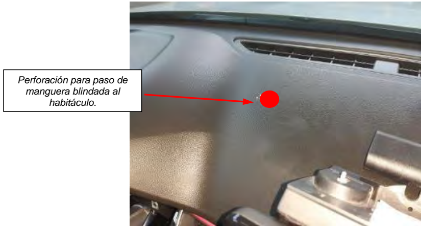
Fig. 4.1.2. Vista del orificio para paso de la manguera blindada por el salpicadero.
