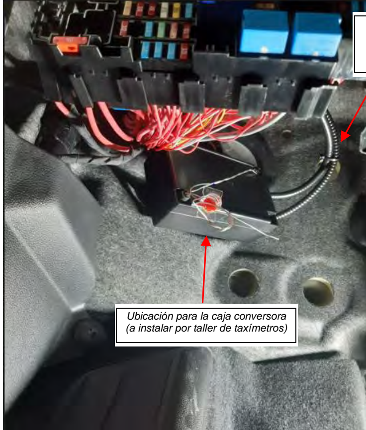
Fig. 2.4. Detalle de la ubicación de la salida de la manguera blindada.
