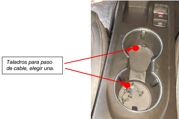
Fig. 5.3.4. Vistas taladro paso de cable de impresora, Opción 1.
