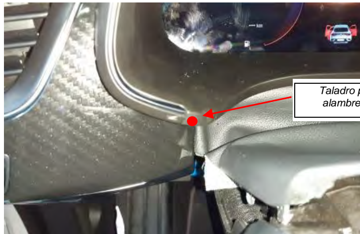
Fig. 2.3.2. Detalle de la posición del orificio para el paso de alambre de precinto.
