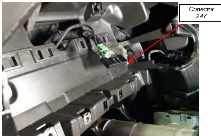
Fig. 1.2. Vista del conector 247 con el cuadro de instrumentos desmontado
