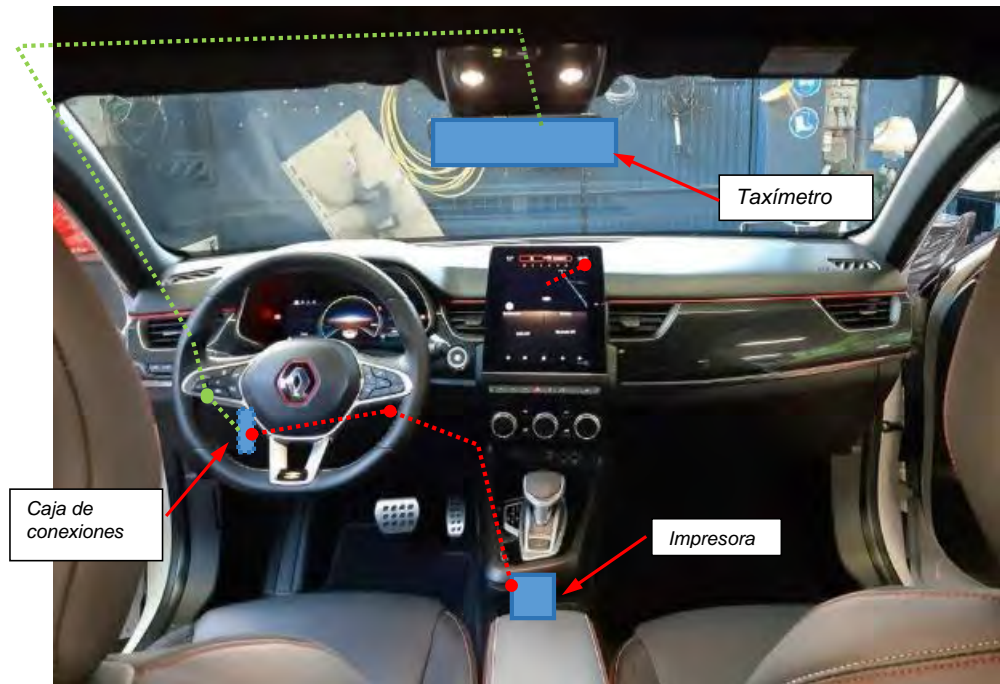
Fig. 4.2.1. Esquema orientativo de las conexiones
