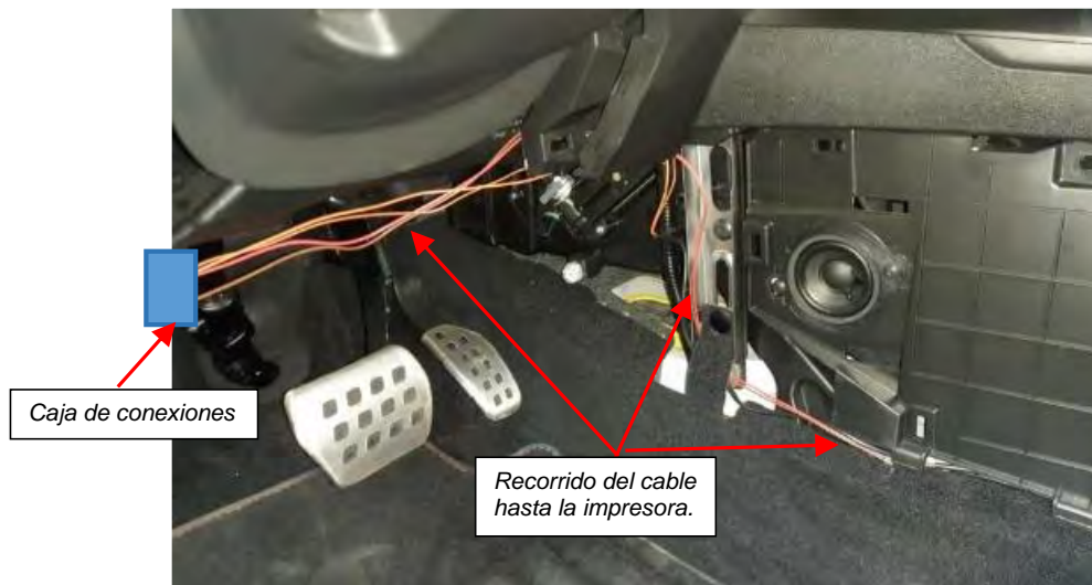
Fig. 5.3.3. Vistas de la disposición de la impresora.
