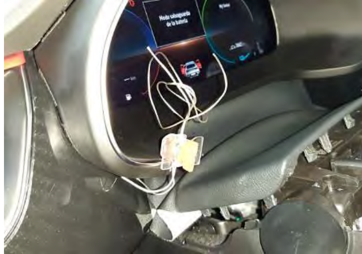
Fig. 2.3.1. Detalle del alambre de precinto.
