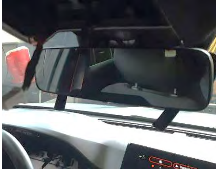
Fig. 5.2.2. Vista del taxímetro de espejo superpuesto sobre el soporte original del retrovisor interior.
