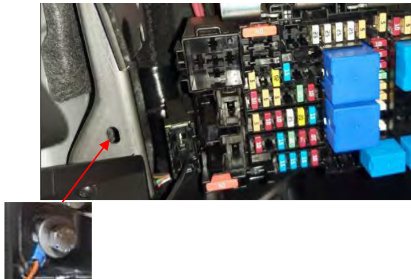
Fig. 2.4. Detalle de conexión negativo de masa a chasis.
