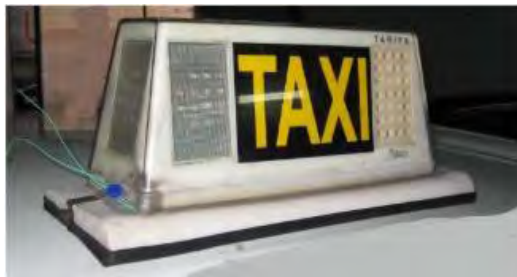
Fig. 6.3. Vista del módulo y su precinto
