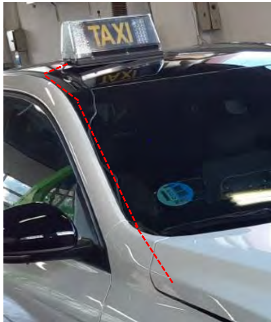
Fig. 6.2.2. Vistas del paso de cable del módulo al compartimento motor
