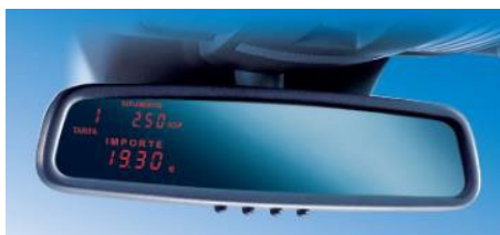
Fig.9. Ejemplo de taxímetro de espejo reemplazando el retrovisor interior original. Deben disponer y ser compatibles con impresoras periféricas
