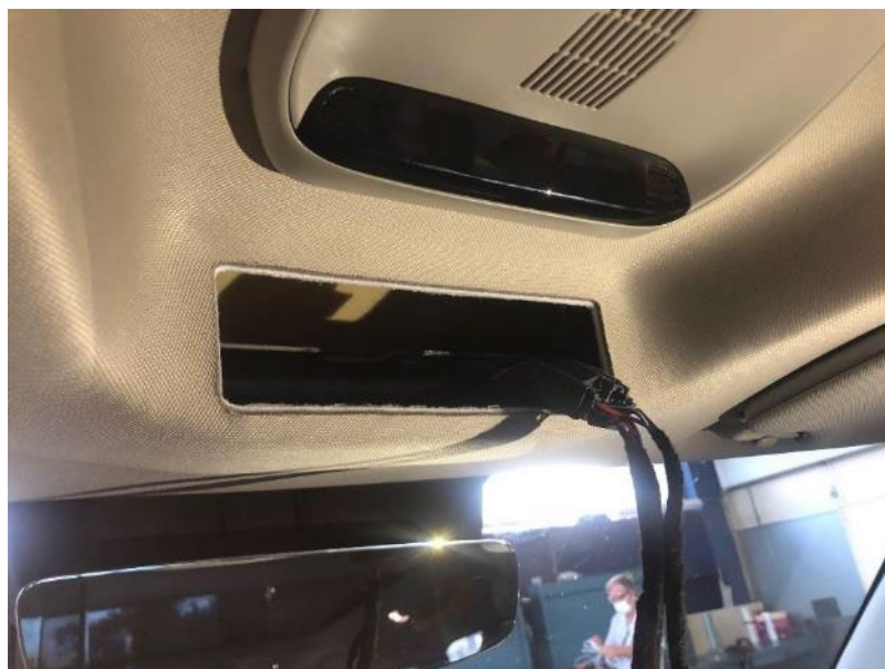
Fig. 1.11. Ubicación prevista para la terminación de la manguera blindada con el cable de señal..
