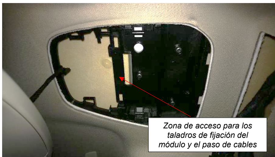
Fig. 2.24. Vistas de la zona de fijación del módulo y paso de cables
