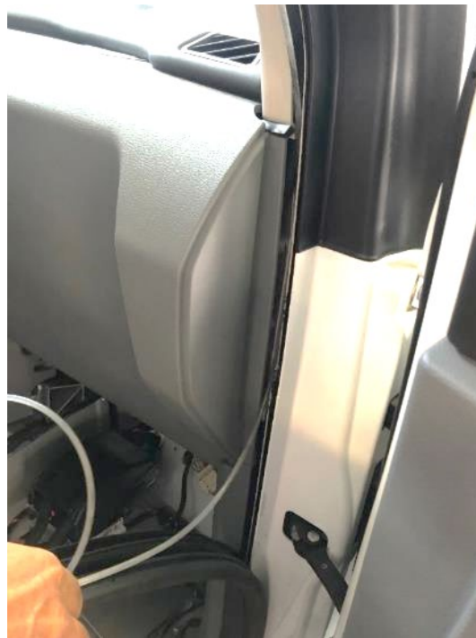
Fig. 2.15. Recorrido cable de impresora a taxímetro
