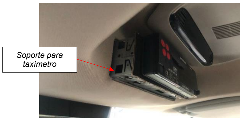
Fig. 2.3. Vistas del montaje del taxímetro y del soporte
