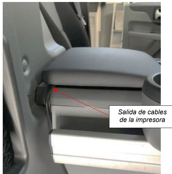
Fig. 2.9. Recorrido cables conexión de la impresora
