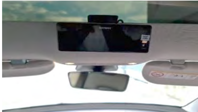
Vistas de taxímetros de consola con soporte interior, en la ubicación prevista en el techo.
