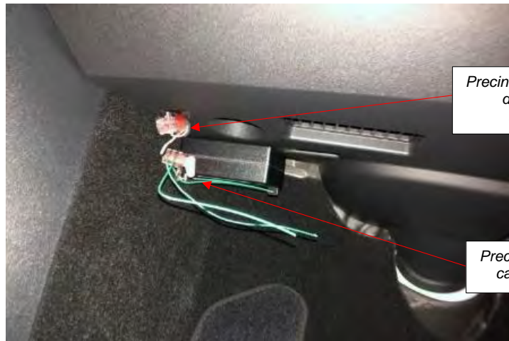
Vista final del conjunto montado y precintado TESLA, caja de conexiones superpuesta.
