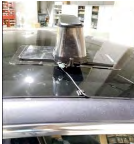
Vista de cable fijado con grapas adhesivas, módulo desplazado
