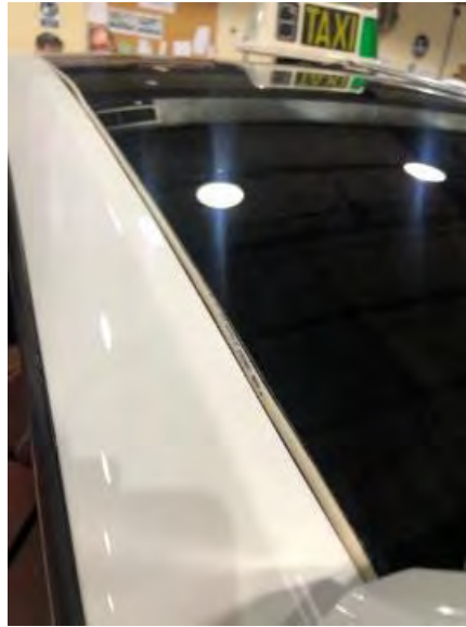
Vista del recorrido del cable del módulo por el vierteaguas lateral izquierdo hasta la zona posterior
