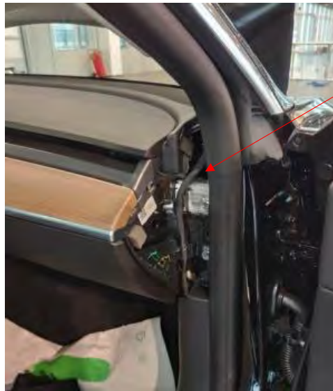
Paso para el cable del módulo
