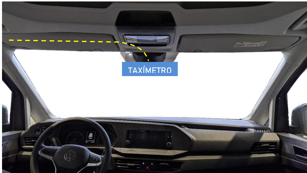
Figura 29. Trazado del cable del módulo tarifario
