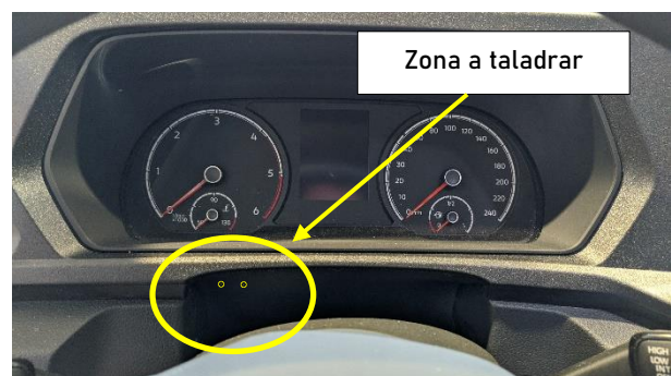
Figura 16. Detalle zona a taladrar.
