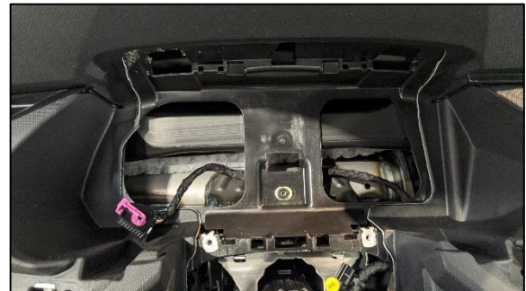
Figura 7. Cuadro de instrumentos desmontado.
