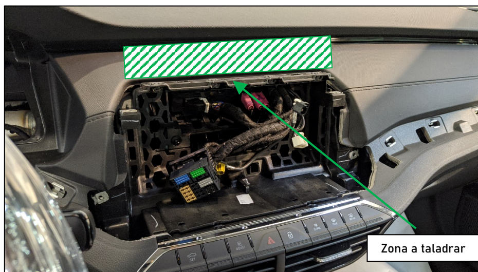
Figura 22. Zona a taladrar para el paso de mangueras.
