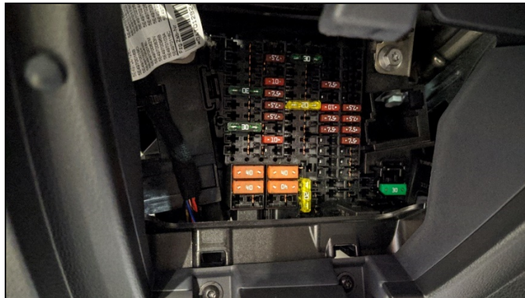
Figura 2. Caja de fusibles.
