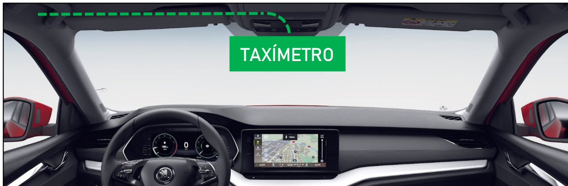
Figura 30. Trazado del cable del módulo tarifario
