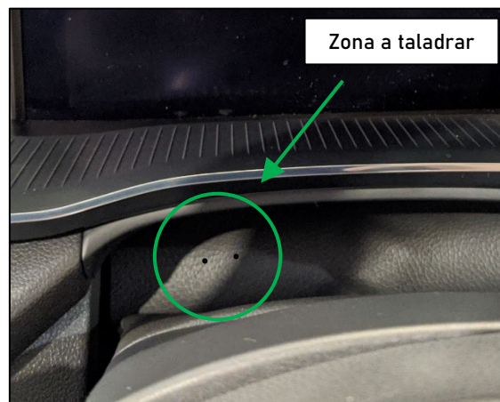
Figura 17. Detalle zona a taladrar.
