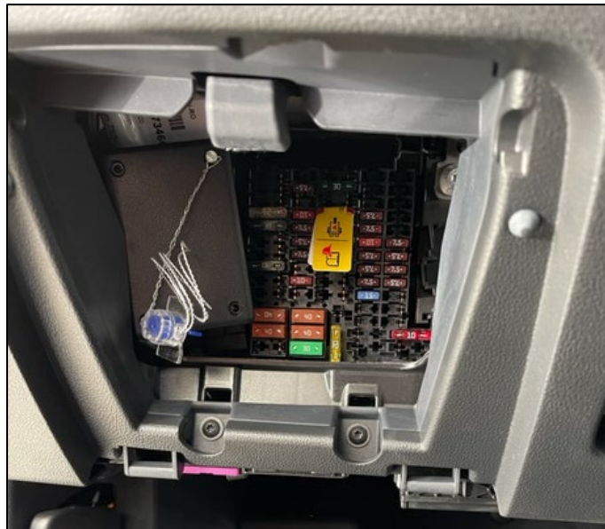
Figura 5. Instalación y precintado de la caja de conexiones.
