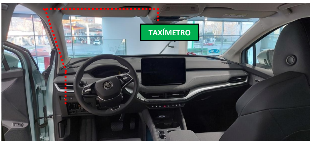
Figura 18. Recorrido de la manguera del taxímetro.
