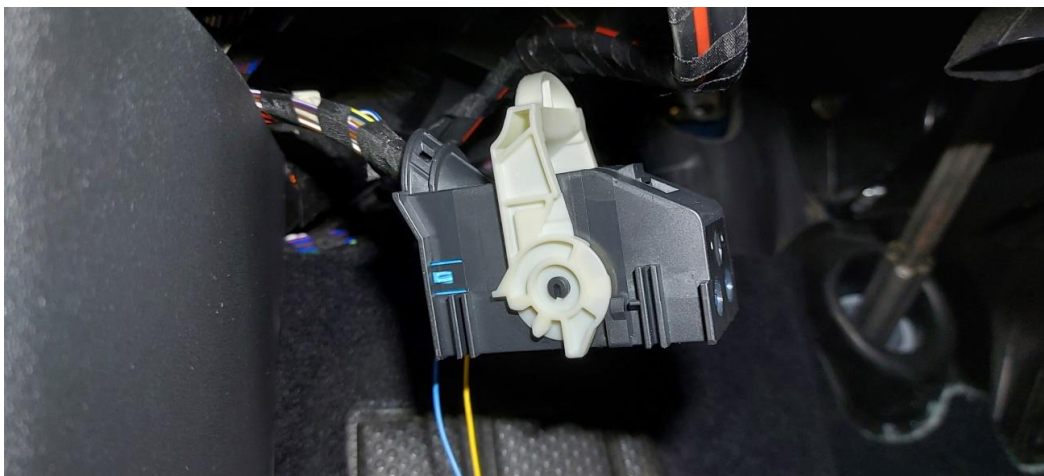
Figura 6. Clema A de 73 pines de la unidad de control de la red de abordo.
