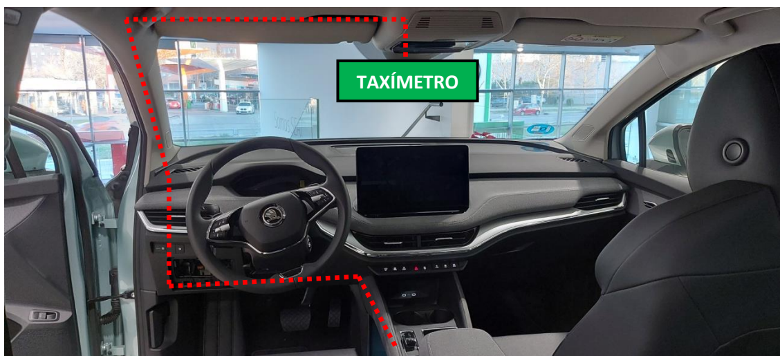
Figura 23. Recorrido del cable de impresora.
