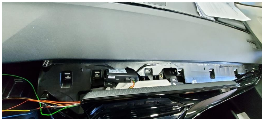
Figura 12. Ubicación del adaptador de CAN-BUS.
