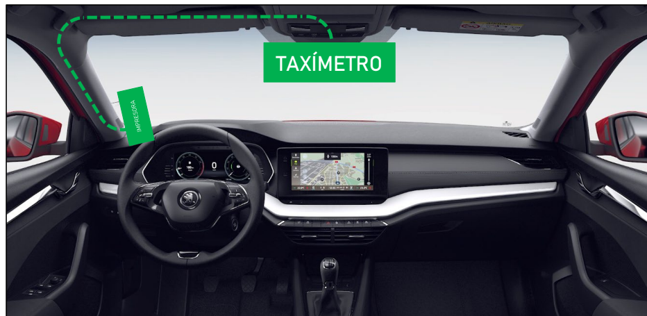
Figura 33. Recorrido cable de la impresora.
