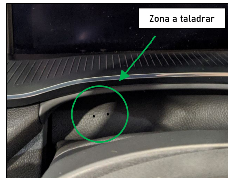
Figura 17. Detalle zona a taladrar.
