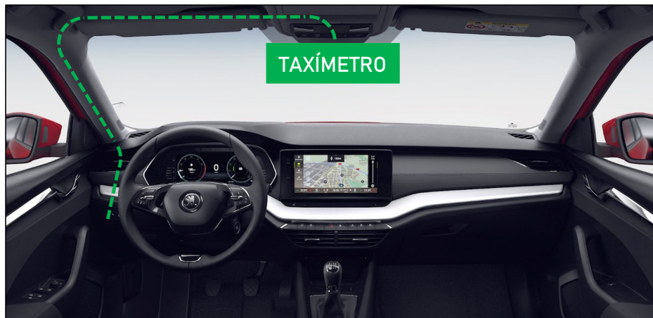
Figura 29. Recorrido de la manguera del taxímetro.
