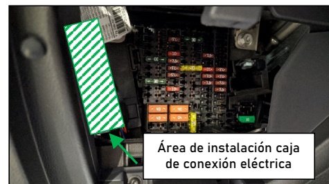
Figura 4. Área de instalación caja conexión eléctrica.
