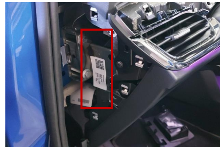
Figura 4. Ubicación caja de conexiones.
