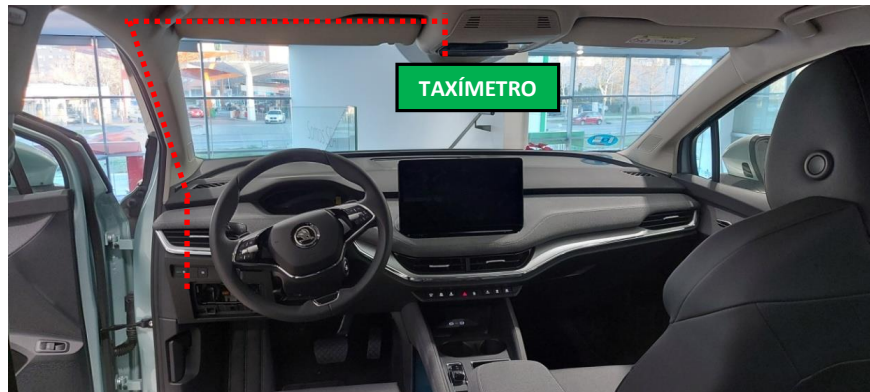
Figura 18. Recorrido de la manguera del taxímetro.
