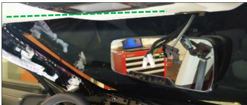
Recorrido del cable del módulo tarifario
