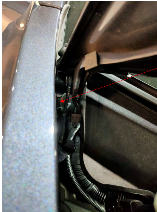
Paso del cable del módulo
