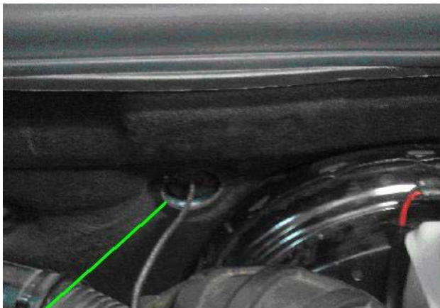
Paso de la manguera de señal al habitáculo interior
