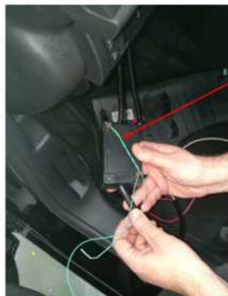
Precintado caja adaptadora de señal
