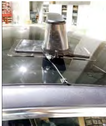
Vista de cable fijado con grapas adhesivas, módulo desplazado
