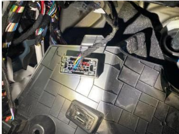
Esquemas de la ubicación y desmontaje del guarnecido para acceso al conector X181
