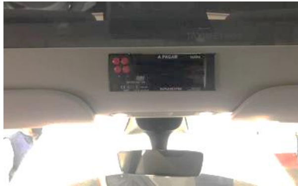
Fig. 8. Vista de un taxímetro de consola en la ubicación prevista en el techo.
