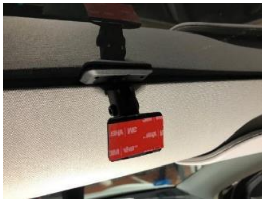
Vista de un taxímetro de consola con soporte a cristal, en la ubicación prevista en el techo.
