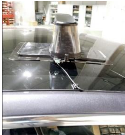
Vista de cable fijado con grapas adhesivas, módulo desplazado
