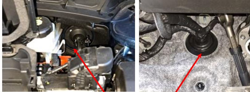
Taladro pasamuros vano motor e interior, detrás de la columna de dirección
