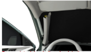
Desmontaje del embellecedor del pilar delantero
