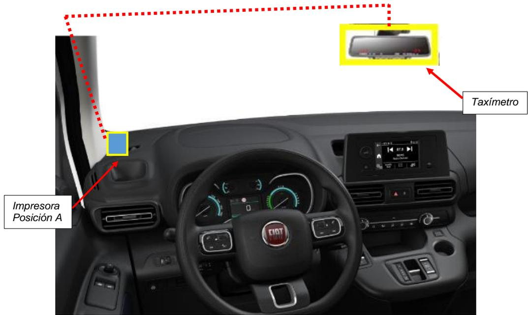
**IMPORTANTE:** El mazo de conexiones de la impresora deberá discurrir por el interior de guarnecido del pilar A siempre por encima del módulo de airbag lateral y asegurando la no interferencia del mismo con la zona de despliegue del airbag.
