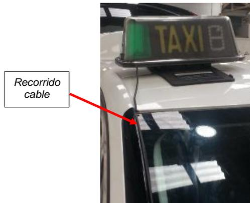
Llevaremos el cable por el interior del vierteaguas hasta el compartimento motor, ahuecamos un poco la junta que se encuentra en el final de la luna para brisas, y guiamos el cable por el interior del guarnecido del montante parabrisas, por todo el largo de este mismo, hasta que llegamos a la zona de la batería, desde donde guiamos el cable hasta el pasamuros. Desde ahí llegaremos a la zona de la BSI.
